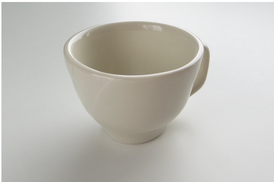
Kuva 46. Valmis espressokupin prototyyppi lasituspolton jälkeen.
