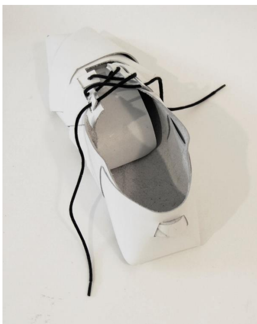
Kuva 28. Sivukappaleiden kulmien kielekkeet pujoteltuina kengän takaosassa.
