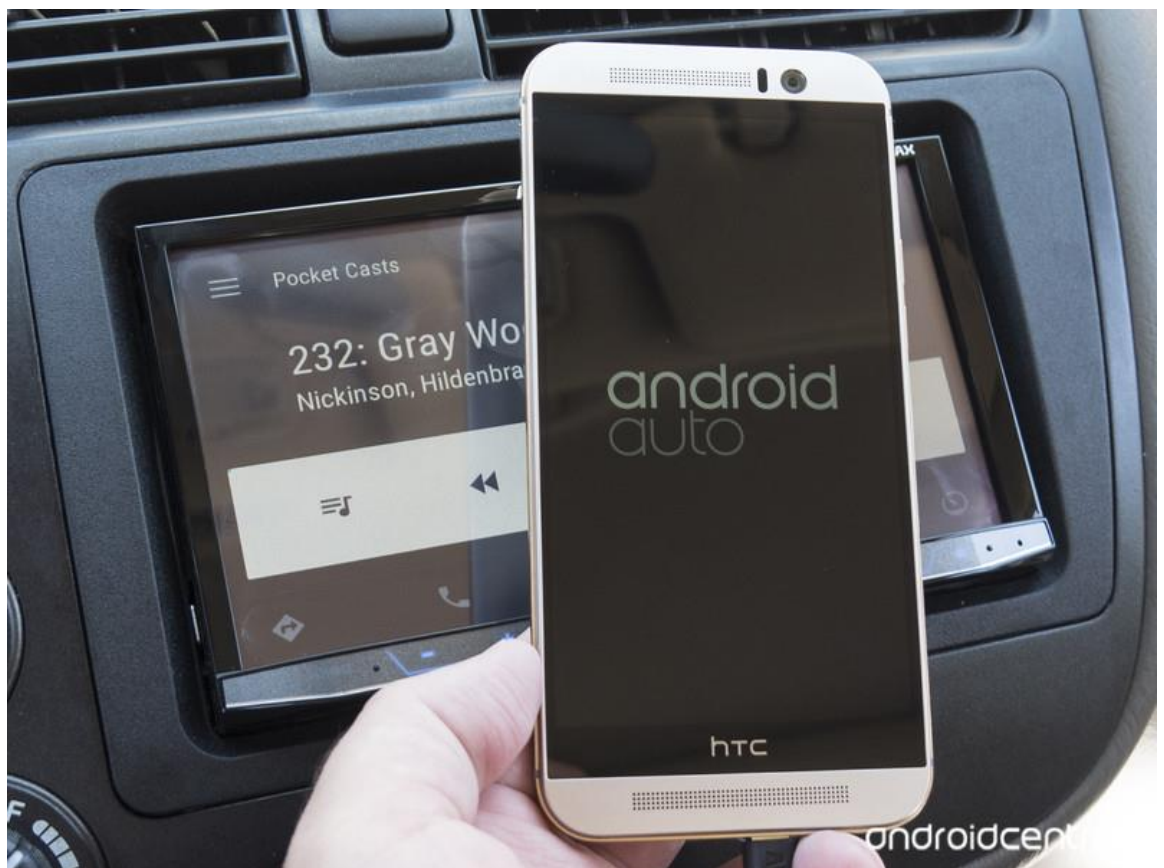
Kuva 6. Android-älypuhelin yhdistettynä auton infotainment-järjestelmään käyttäen Android Auto -järjestelmää. (Androidcentral 2015.)
