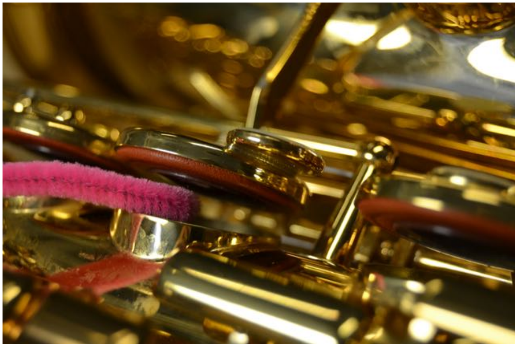
Kuva 10. Tyynyn ja ääniaukon puhdistus. Kuvassa piippurassi.
