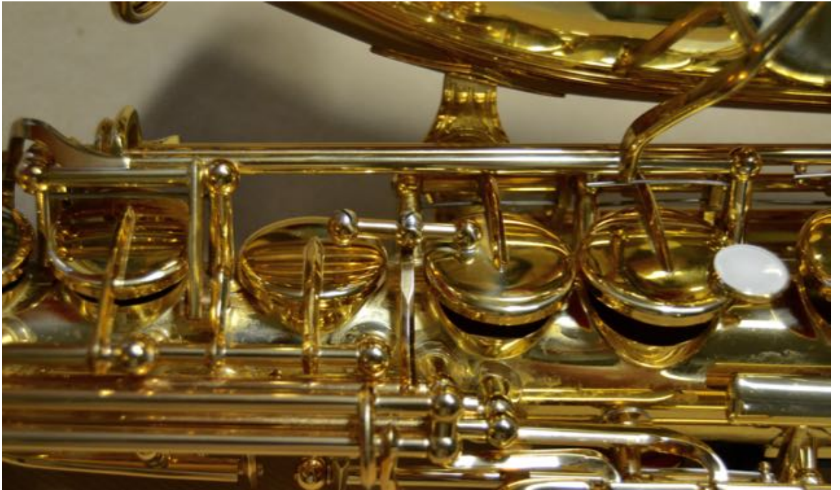
Kuva 35. Gis- ja Bb-läpän säätöruuvit
