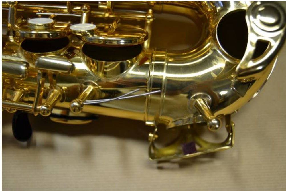
Kuva 33. C-läpän jousi taivutuksen jälkeen
