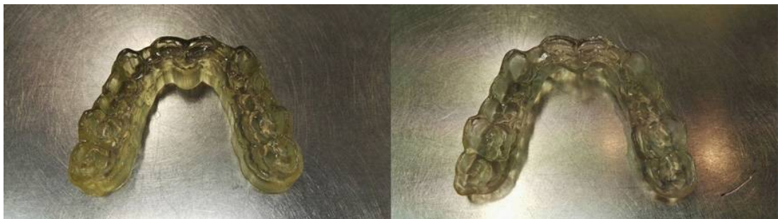
Kuvio 10 Tulostettu kisko ennen ja jälkeen tukiaineen poistamista
