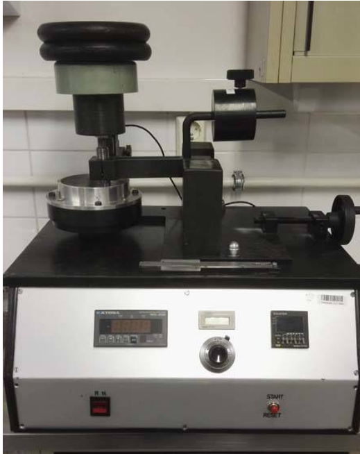
Kuvio 1 Pin-On-Disc -materiaalikulutuskoejettä
