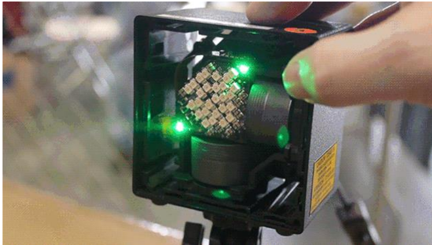
Kuva 12. Lighthouse –sensori avattuna. (Buckley 2015)
