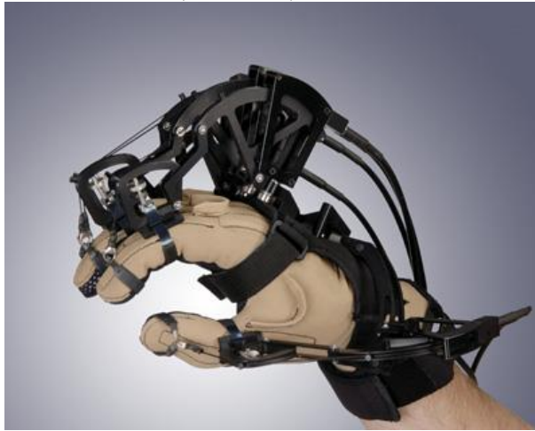
Kuva 14. CyberGrasp –datahanska. Tekniikkaa voisi mielestäni suhteuttaa vuosikymmeniä sitten julkaistuihin vr-laseihin, ja tulevaisuudessa tämä näyttää varmasti alkukantaiselta. (CyberGlove Systems n.d.)
