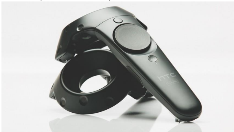
Kuva 13. HTC Viven liikeseuratut ohjaimet: ohjaimen etuosassa on kosketuslevy ja takana sijaitsee kaksiasentoinen liipaisin. (Prasuethsut 2016)
