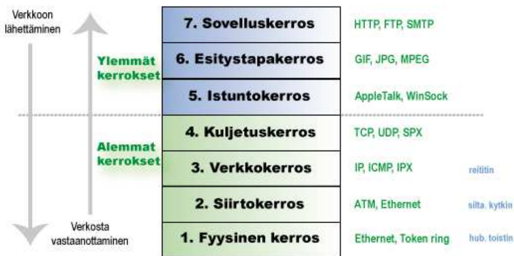
Kuva 10. HTTP toimii OSI-mallin ylimmässä kerroksessa.
