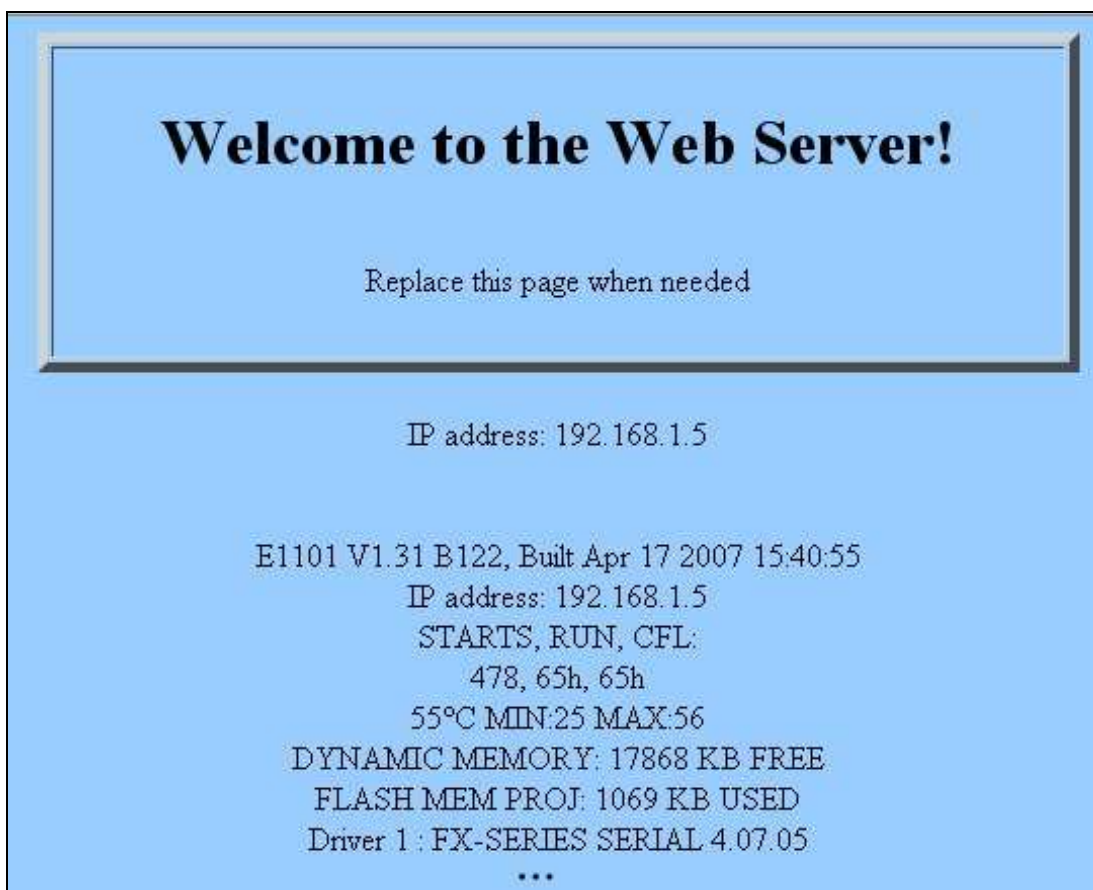
Kuva 5. Operointipaneelin oletussivu sisälsi yleistietoa paneelista, kuten käynnistykerrat, käyntiajan ja vapaan muistin määrän.
