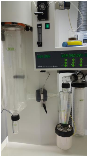
KUVA 7. Sumukuivauslaitteisto. (Kuva: R. Moilanen 2016.)
