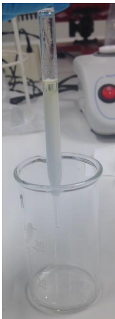
KUVA 8. PVPP-pylväs. (Kuva: R. Moilanen 2016.)
