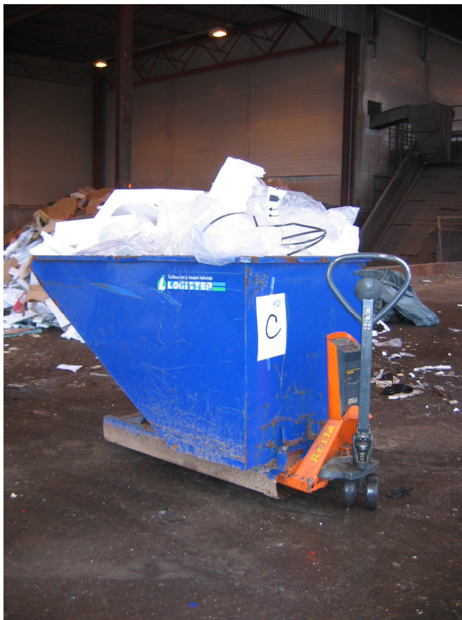
KUVIO 3. Kuviossa ovat punnitseva haarukkavaunu, kontti ja kontissa olevaa muovipakkausjätettä (taustalla näkyy osa murskauslaitoksesta).
