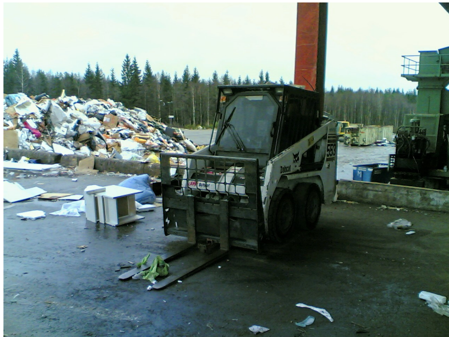
KUVIO 4. Täysien konttien tyhjennyksessä käytettiin lähes aina kuviossa olevaa Bobcat -konetta.
