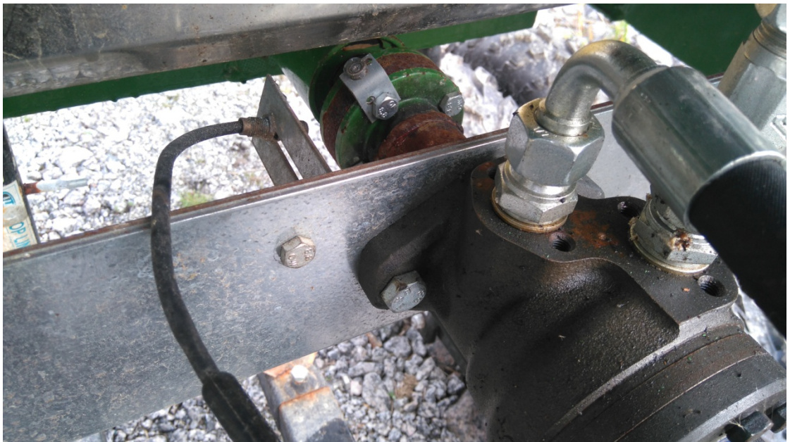
Kuvio 6. Pyörintänopeusanturi mittaa levittimen käyttöakselin kierroksia
