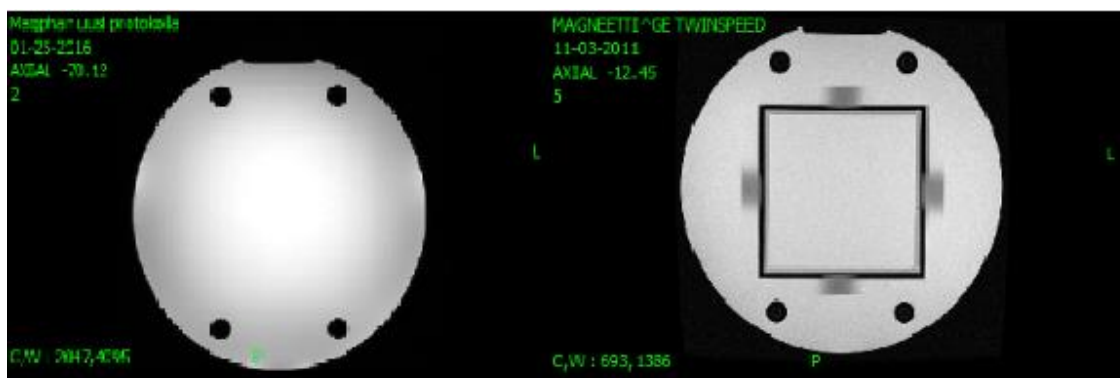
KUVA 45 Oikea levyn halkaisijan keskiarvon laskemiseen käytetty kuva ja kuva, jota käytettiin virheellisesti
