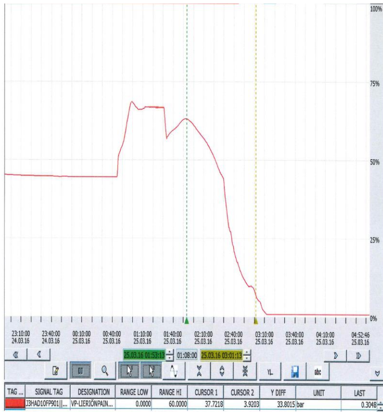
Kuva 3. Kuvassa 3. kursorit on asetettu osoittamaan välipainepainehöyryn paineen laskua n. 37,7 bar – 4 bar, joka kestää n. 1 tuntia 8 minuuttia.
