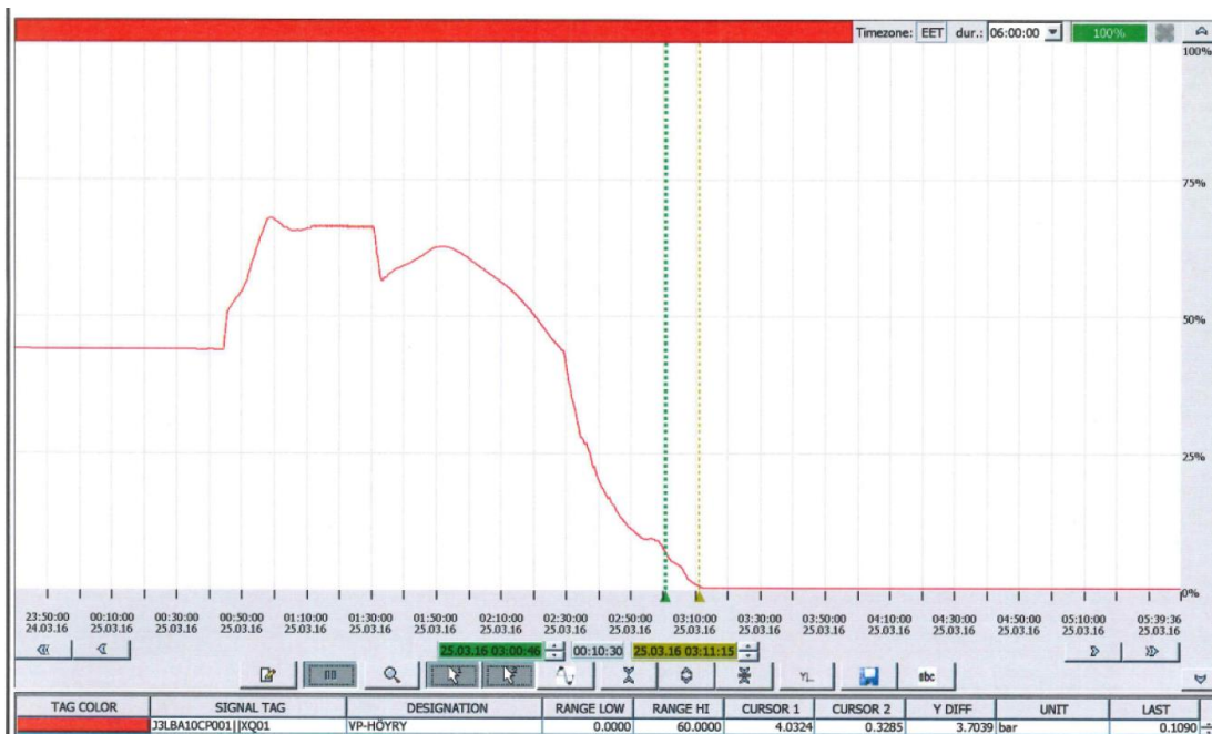
Kuva 4. Kuvassa 4. on nähtävissä trendi lämmöntalteenottokattilan välipainehöyryn paineesta alajajovaiheessa. Kursorit on asetettu osoittamaan paineen laskua lukemasta n. 4 bar – 0,3 bar, joka kestää n. 10 minuuttia 30 sekuntia.
