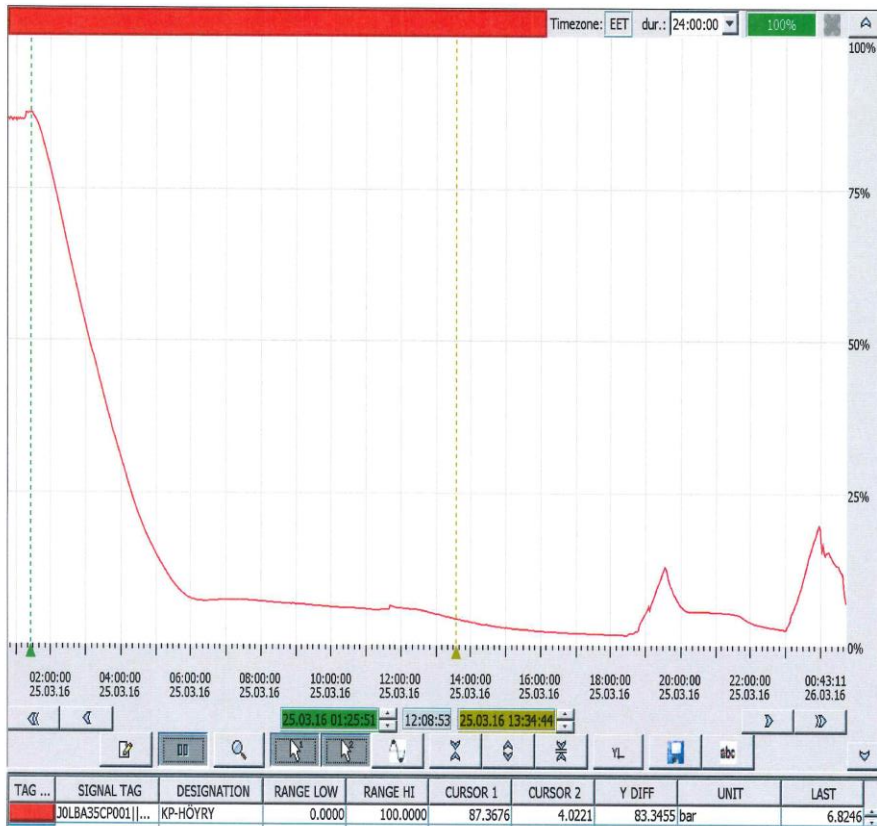
Kuva 1. Kuvassa 1. kursorit on asetettu osoittamaan korkeapainehöyryn paineenlaskua n. 87 bar – 4 bar, joka kestää n. 12 tuntia 9 minuuttia.
