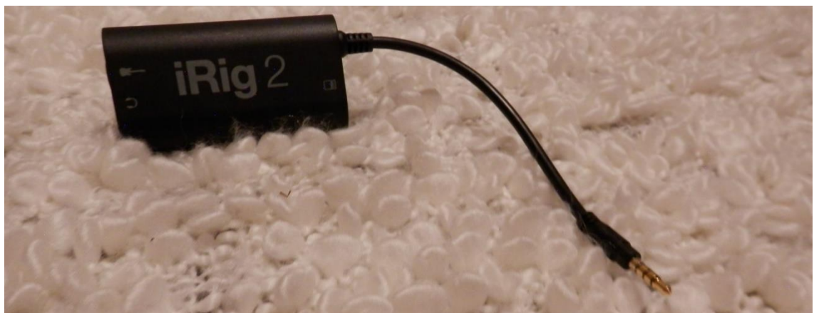
KUVA 14: IK Multimedian valmistama iRig2 joka kytketään iPadin kuulokeporttiin. Tämä lisälaitte mahdollistaa kitaran kytkemisen iPadin 3.5mm kuulokeporttiin joka si-
