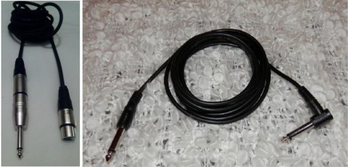
KUVA 6: Vasemmalla mikrofoneissa käytettävä XLR –kaapeli jossa urospäässä kiinni 6.3mm adapteri. Oikealla 6.3mm jakkikaapeli, jolla kitara liitetään vahvistimeen sekä äänikorttiin.
