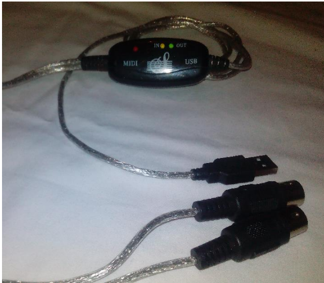
KUVA 8: Yksinkertainen johto mahdollistaa MIDI -signaalien sisään ja ulostuonnin tietokoneesta.
