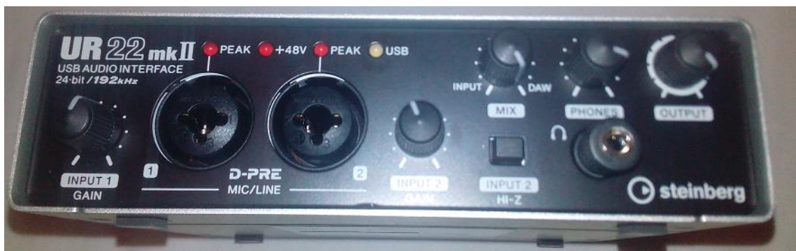
KUVA 7: Steinberg:in UR22 ulkoinen äänikortti, jonka kaksia sisäänvientiä sisältävät sekä XLR -liittimen että 6.3mm jakkiliittimen liittämismahdollisuuden.
