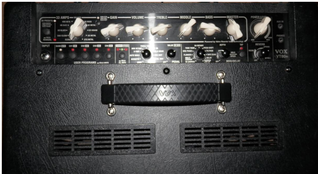
KUVA 13: Käytössäni olevasta VOX kitaravahvistimesta nähdään perinteiset säätönupit sekä niiden toiminnot. Valvetronix:in valmistama vahvistin mallintaa myös kuuluisia tunnettuja efektejä useista kappaleista, jotka on lueteltu laitteen käyttöohjeissa.
