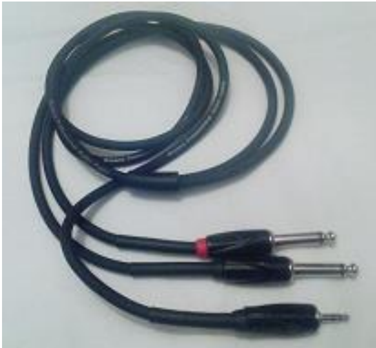
KUVA 5: iPadin kanssa käytettävä Y-kaapeli muuttaa kuulokeliitännästä tulevan 3.5mm liittimen stereosignaalin kahdeksi 6.3mm liittimen monosignaalksi.
