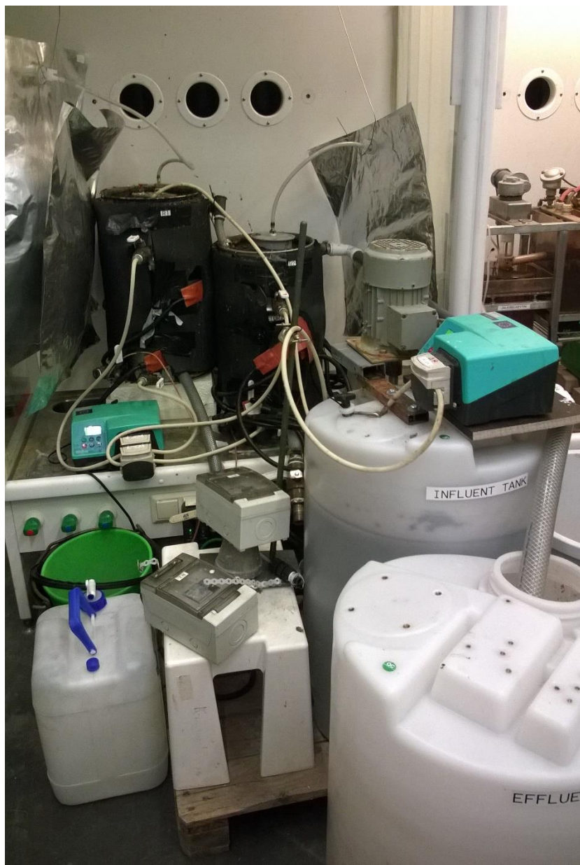
Kuva 6. Laboratorio mittakaavan tätekappalekolonnireaktori laitteisto(Koskenlahti, 2017)
