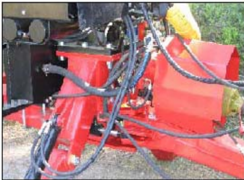
Kuva 11. Kärryn oma hydraulikoneikko. [16]
