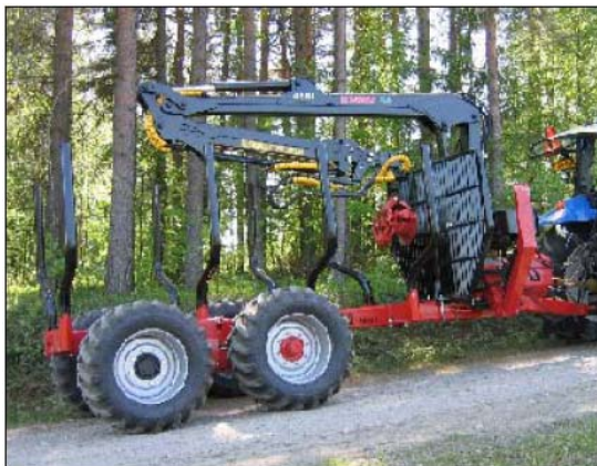
Kuva 9. Hydraulisesti vetÄvÄ metsÄperÄvaunu. [16]
