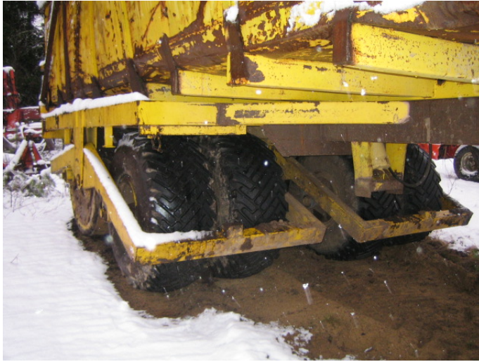
Kuva 8. KÄrryn erilliset telirungot.
