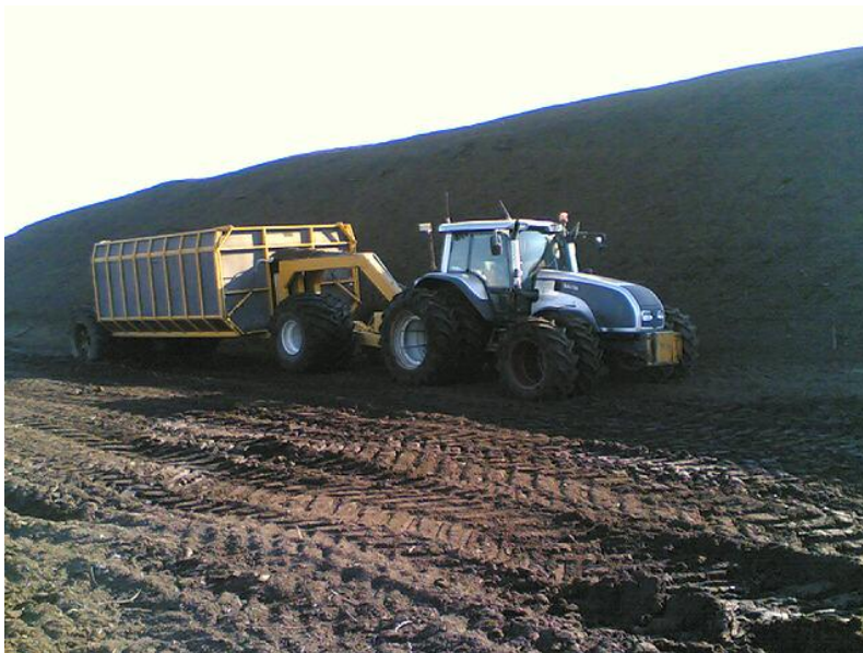
Kuva 6. Traktori ja mekaanisesti vetävä turvevankkuri.
