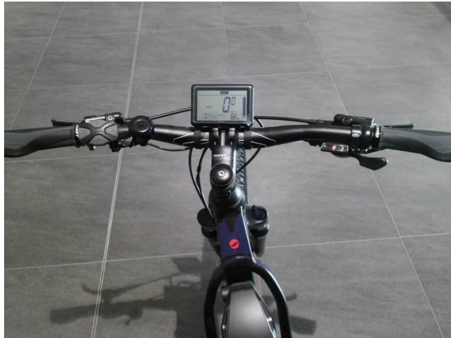
Kuva 5. Sähköavusteisen polkupyörän ohjaustanko. Tangosta löytyvät nopeudensäätimet, vaihteet ja nopeusnäyttö. Kaikissa sähköavusteisissa polkupyörissä ei ole nopeusnäyttöä.
