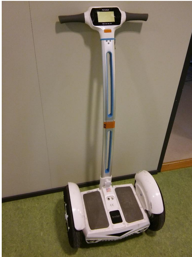
Kuva 3. Itsestään tasapainottuvan sähköisen ajoneuvon vauhtia säädellään kuljettajan oman kehon painoa siirtämällä. Tällaista laitetta saa käyttää jalkakäytävällä kävelyvauhtia.
