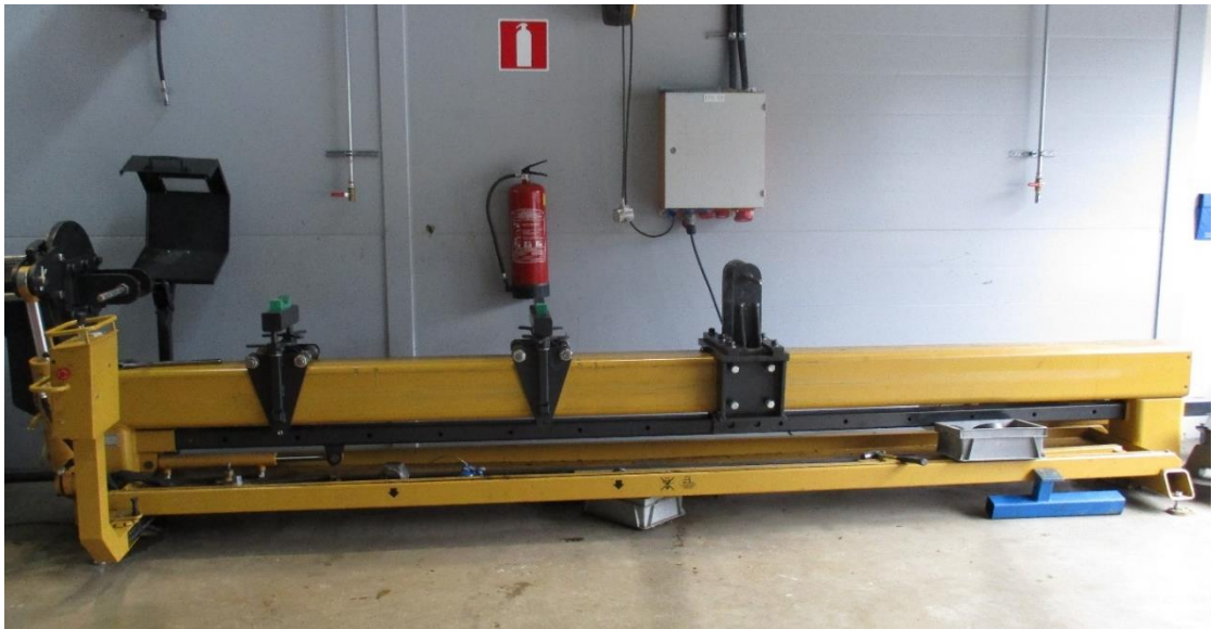
KUVA 14 Hydraulisyntereiden kunnostuspenkki (Karppinen, valokuvat, 2016)
