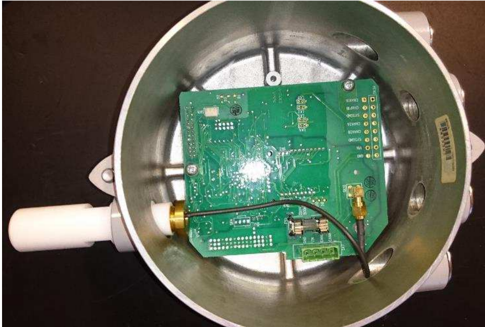
Kuva 22. Langaton yksikkö IQmk3 sopivalla piirilevyllä varustettuna.
