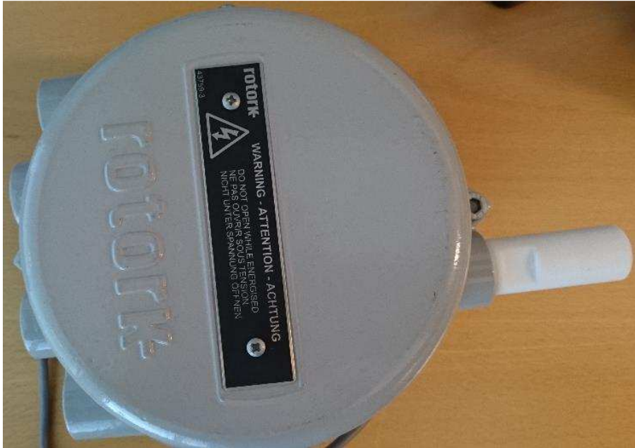
Kuva 10. P3-langattomaan yksikköön liitettävä lähetin -ja vastaanotinyksikkö.
