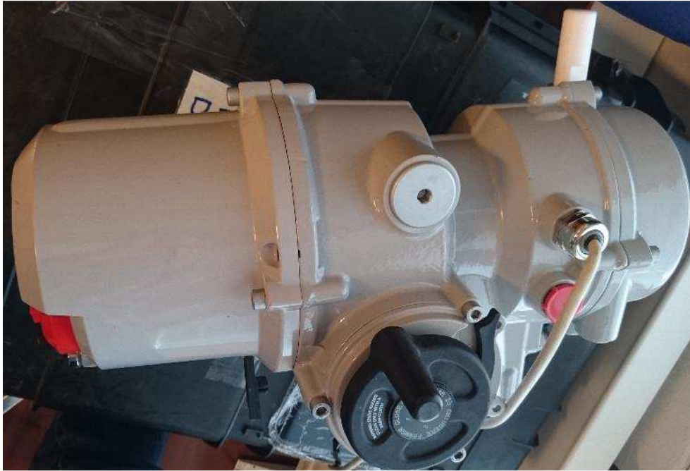
Kuva 8. IQmk2-toimilaite lähetin- ja vastaanotinyksiköllä.
