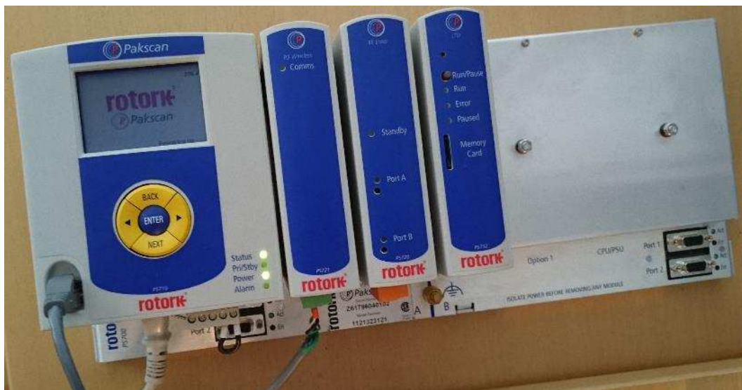
Kuva 9. P3-räkki. Vasemmalta oikealle: keskusyksikkö, langaton ja langalliset moduulit.
