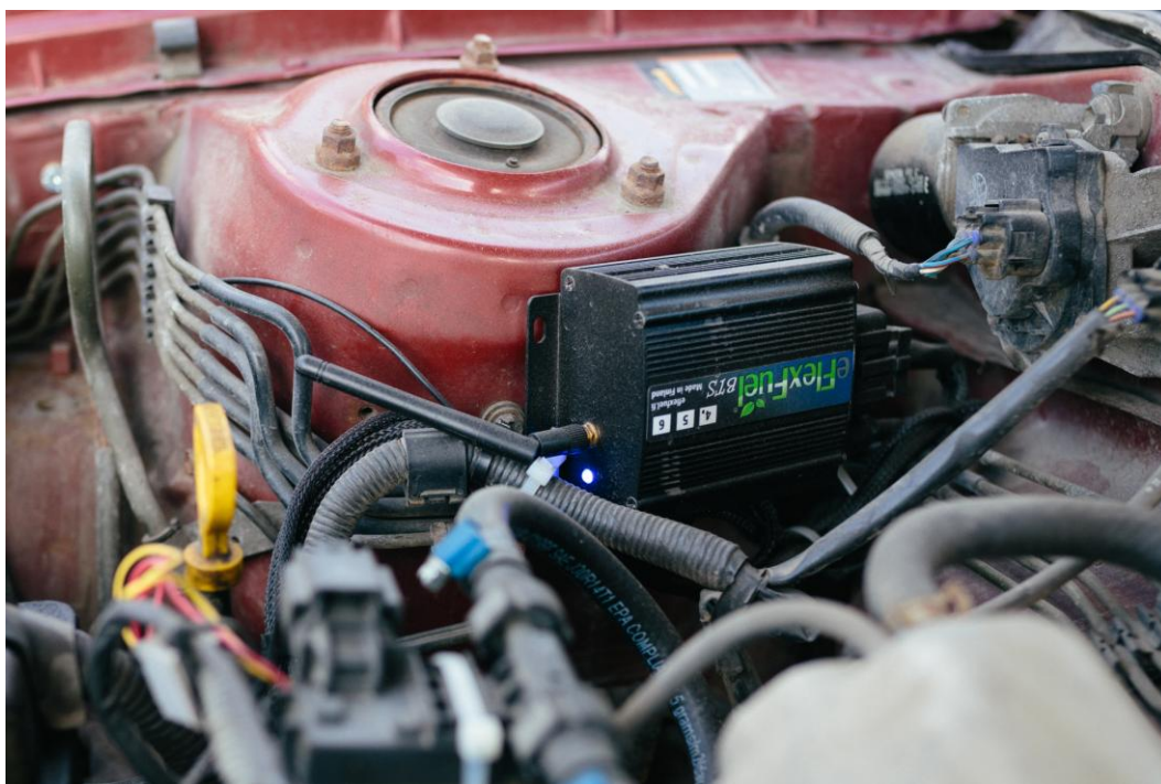
KUVA 4. Muutossarja asennettuna ajoneuvoon
