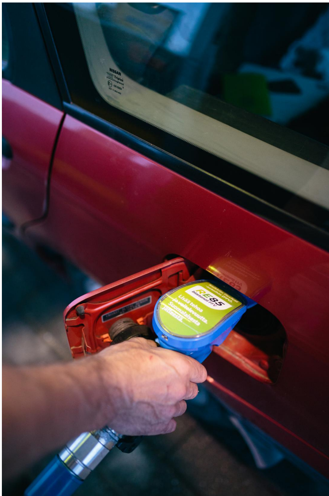
KUVA 1. Etanolikonversion jälkeen ajoneuvoon voi tankata RE85-polttoainetta.
