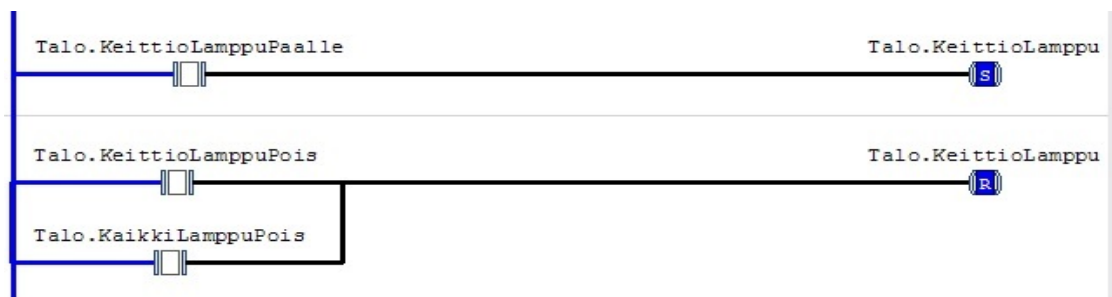
Kuva 27. Keittiönlampun logiikka toiminnassa.
