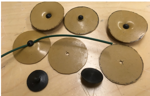
KUVA 22. Mustat POM-laipat ja luonnonkumiset kiinnityslaipat
