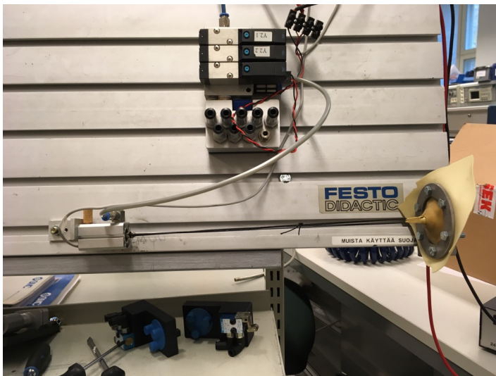
KUVA 20. Laippaa toistuvasti venyttävä testauslaite
