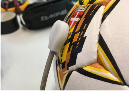
KUVA 27. Liitin palloon kytkettynä
