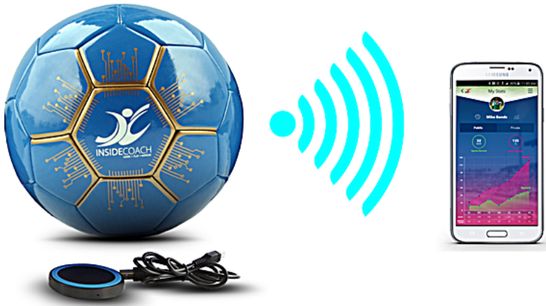
KUVA 4. Pelitiedot reaaliajassa mobiililaitteelle siirtävä Insidecoach-pallo (5)
