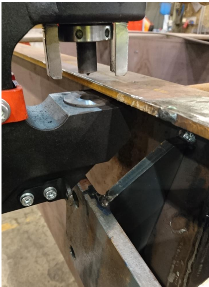
Kuva 13. Lävistyksen ongelmaksi osoittautunut tukirauta.
