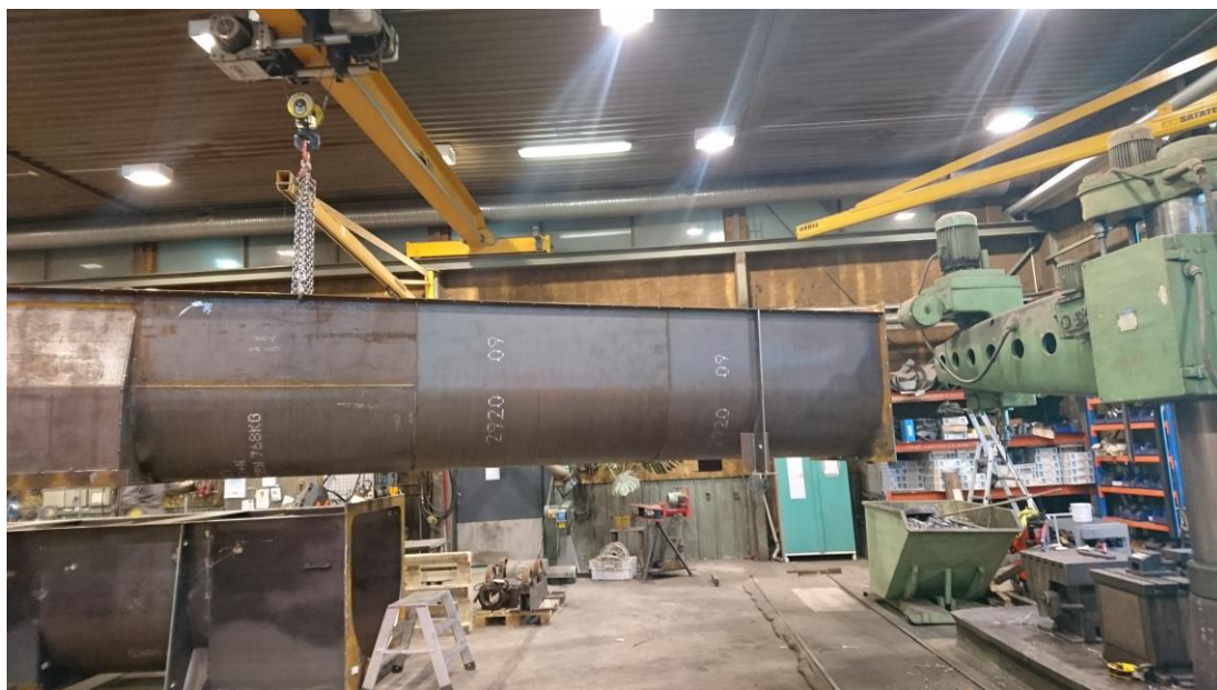
Kuva 12. Ruuvikuljettimen rungon siirto.
