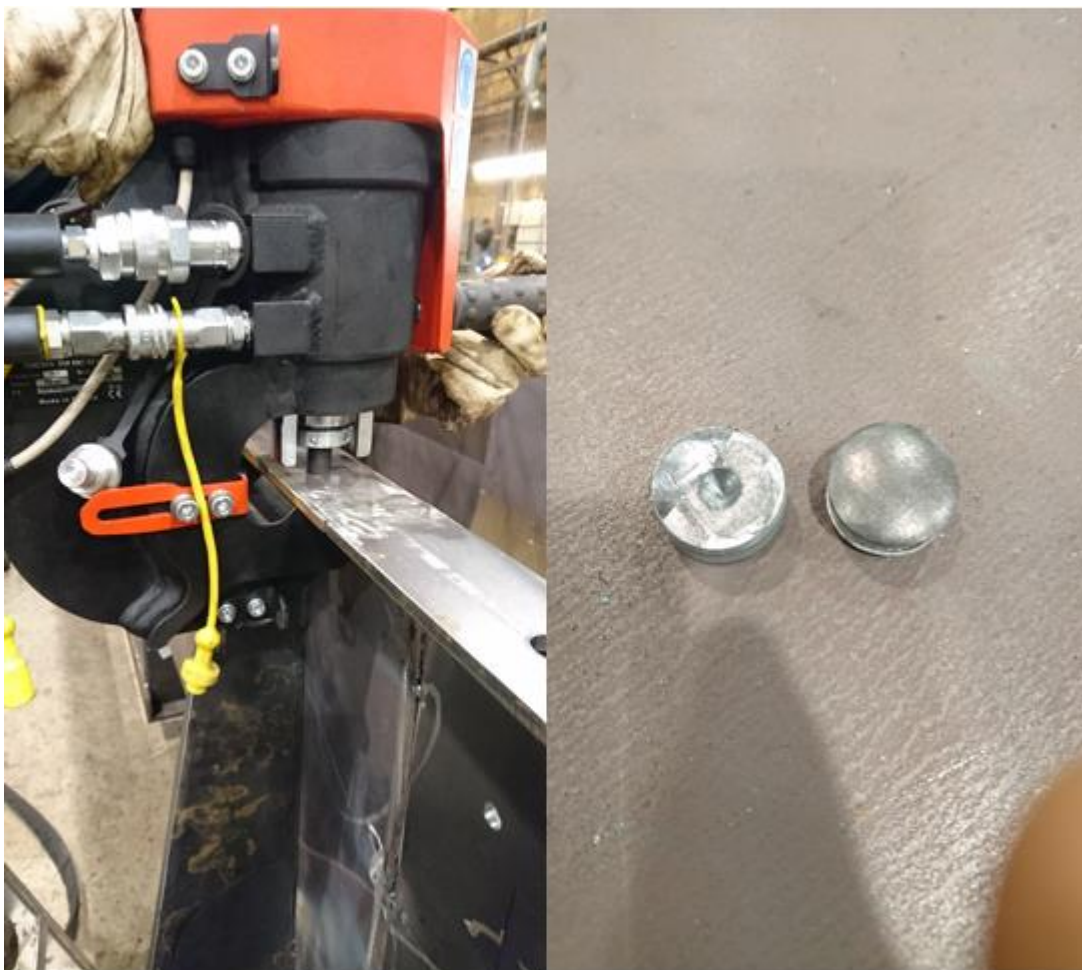
Kuva 5. Lävistäjä käytössä ja reiän valmistuksesta jääneet osat.
