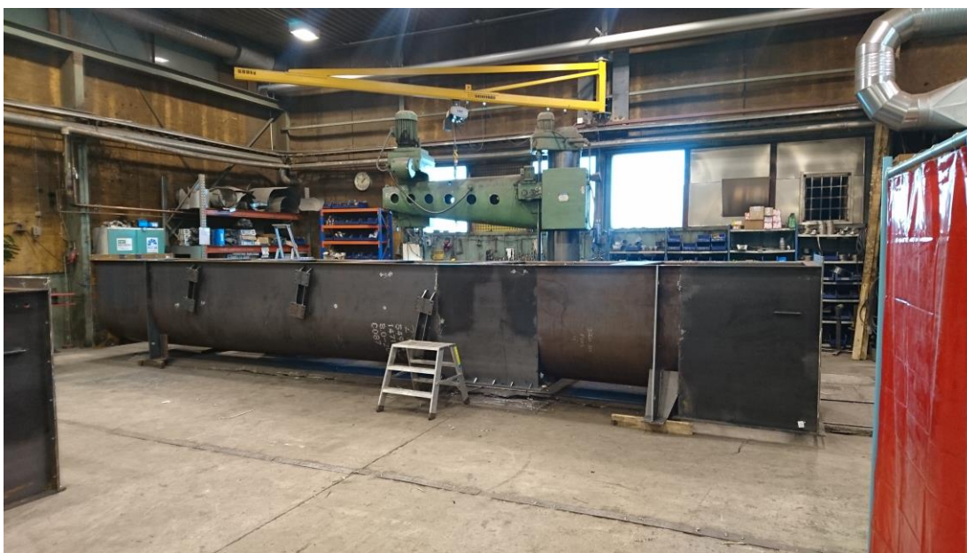
Kuva 2. Ruuvikuljettimen runko säteisporakoneella.
