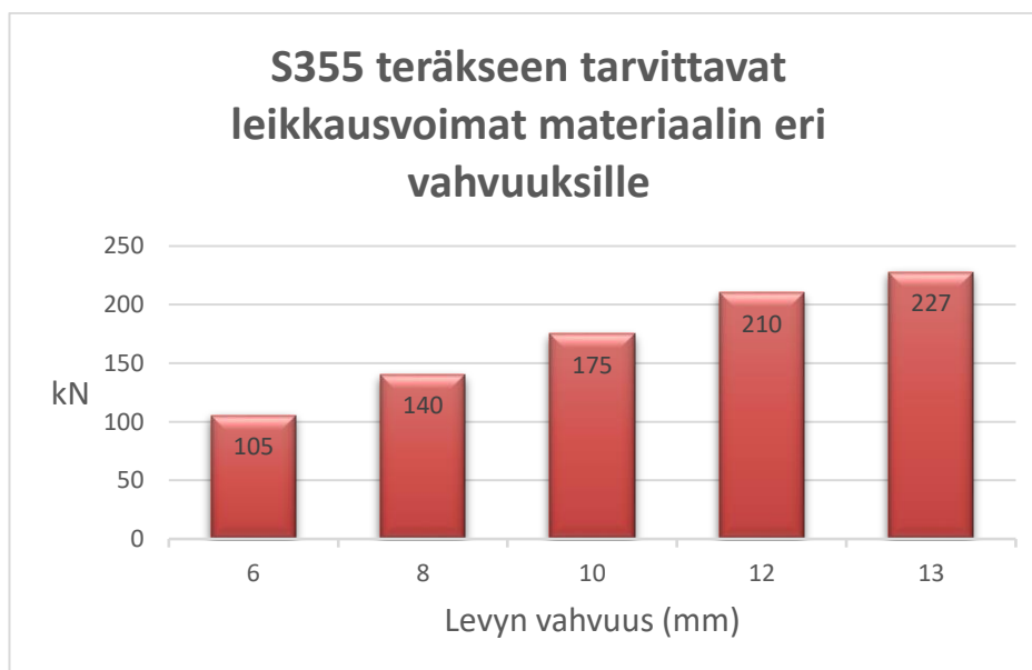
Kaavio 2. Voimat laskettu lävistäjän pistimelle, jonka halkaisija on 16mm.
