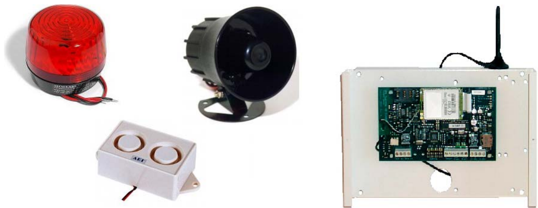
Kuva 24. Paikallishälyttimiä ja robottipuhelin. [11.]
