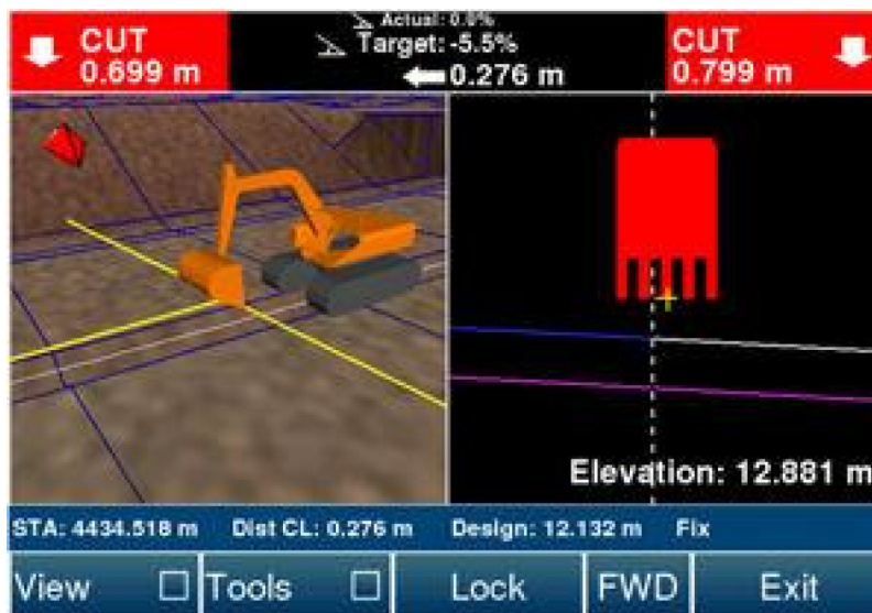
Kuva 1. Kuvassa on näkymä koneohjausjärjestelmän näyttöpäätteeltä. Vasemmalla ylhäällä punaisella taustalla näkyy, paljonko tarvitsee vielä leikata maata päästäkseen tavoitetasoon suhteessa huulilevyn vasempaan reunaan, oikealla ylhäällä sama tieto suhteessa huulilevyn oikeaan kulmaan. [11]
