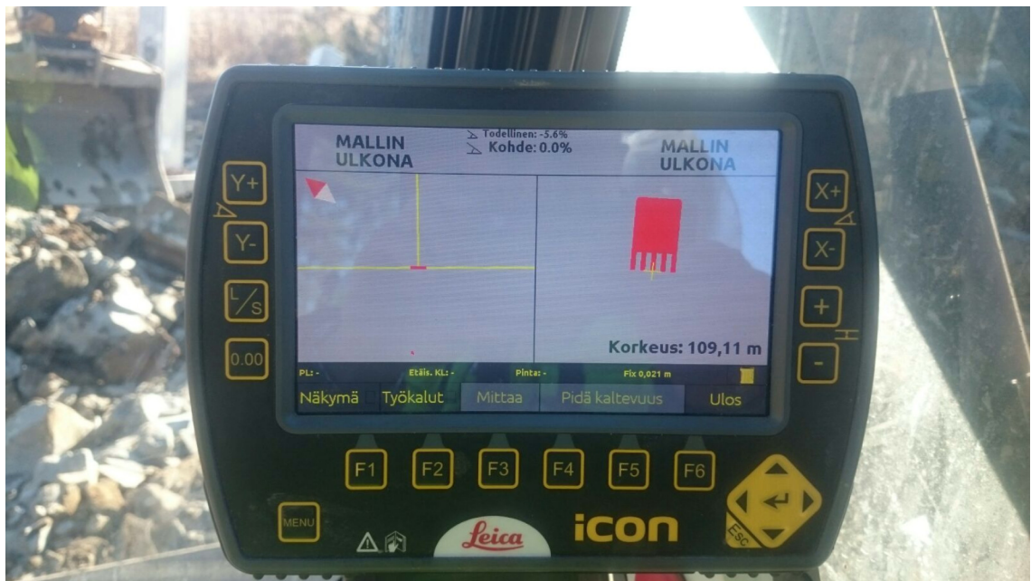
Kuva 6. Leican koneohjausjärjestelmän näyttöpäätte asennettuna kaivinkoneen hyttiin [30]
