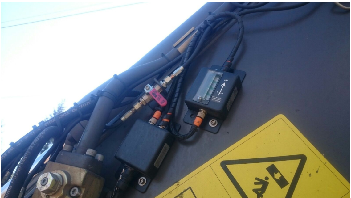
Kuva 7. Anturit kiinnitettynä puomistoon, mittaamassa puomin liikettä. [30]
