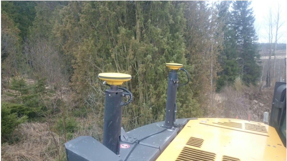
Kuva 5. Koneohjausjärjestelmän näkyvin osa; peräpuntin päällä olevat satelliittivastaanottimet [30]
