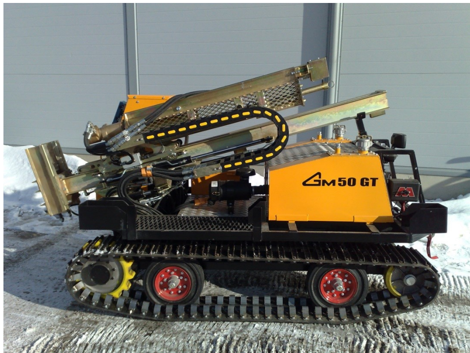
Kuva 4. Suomessa yksi yleisimmin käytössä olevista monitoimikairoista, Geomachinen malli 50 GT (Geomachine n.d.).
