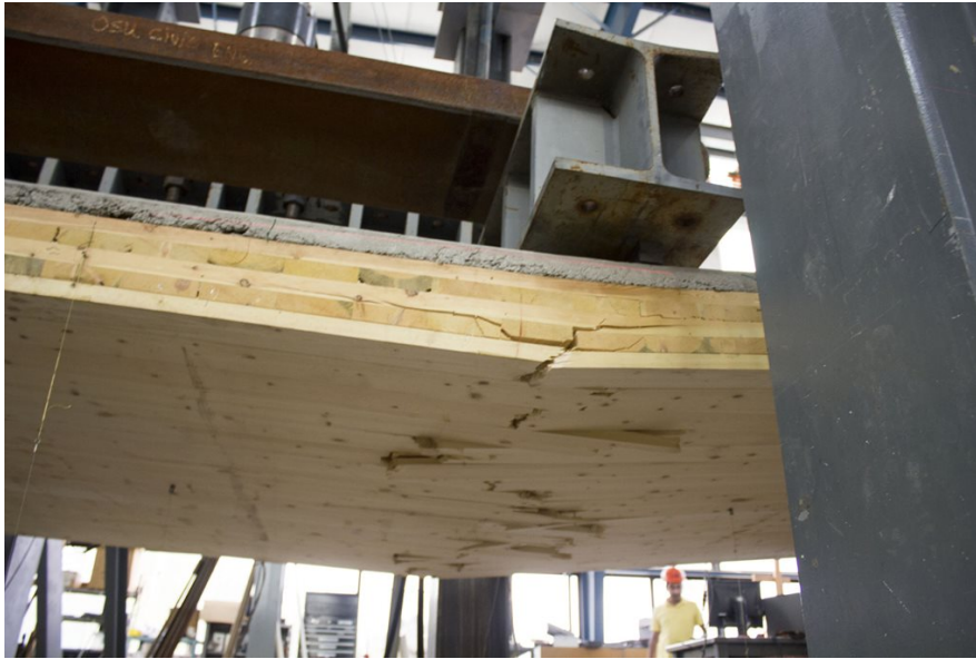
Kuva 2. Prototyypissä käytettävä CLT-betoni liittorakenne (Johnson 2016.)
