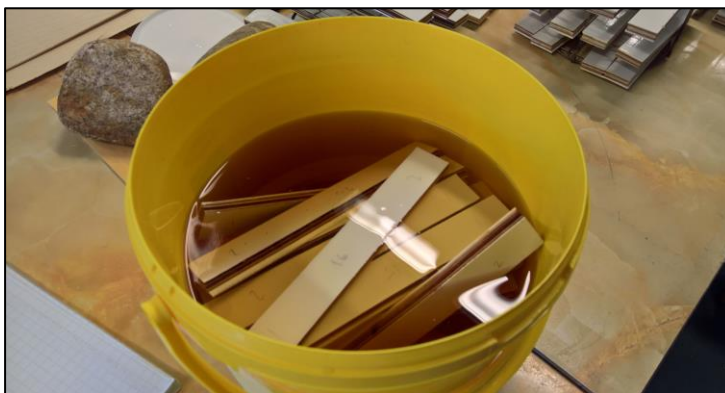
KUVA 23. Vesiupotuksessa olevat koekappaleet
