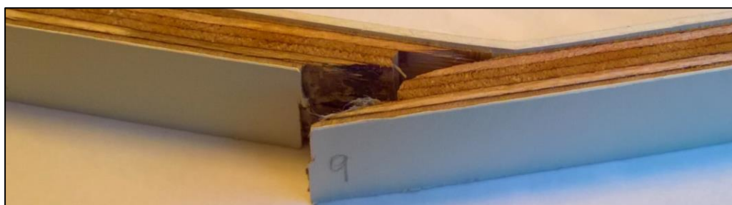
KUVA 32. Pinnoitetun limittymättömän kappaleen numero 9 murtuminen
