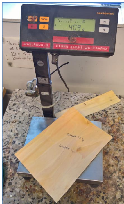
KUVA 28. Vanerin kuivapainon mittaus kuivauksen jälkeen
