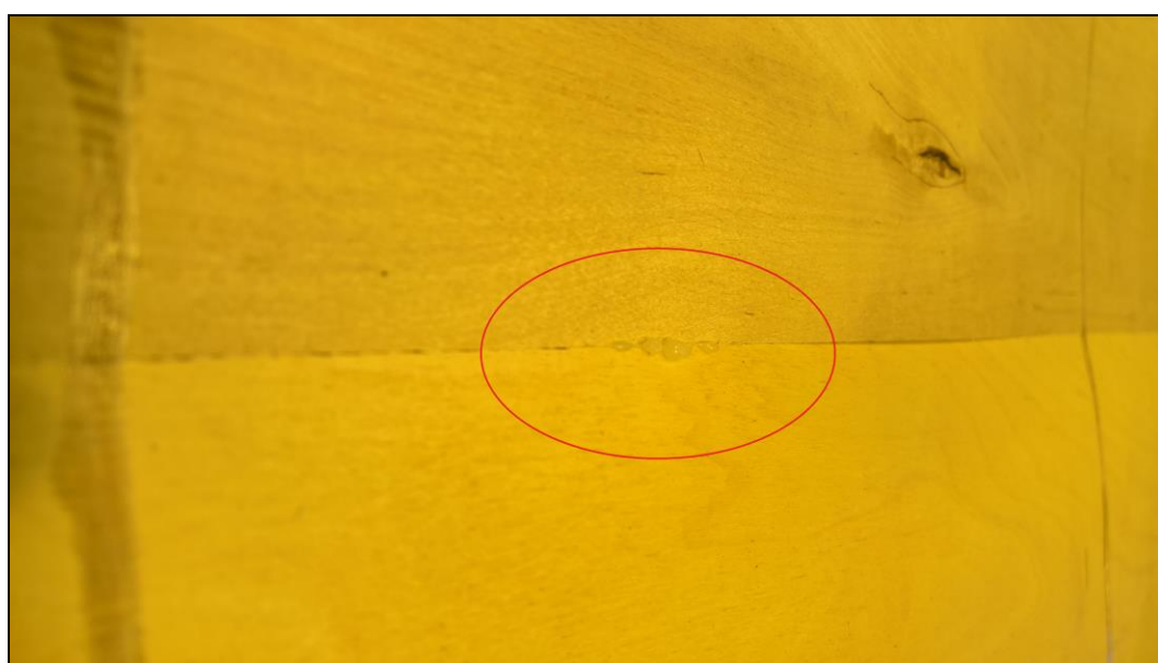
KUVA 19. Puskusaumaan sulatettu liimatippa
