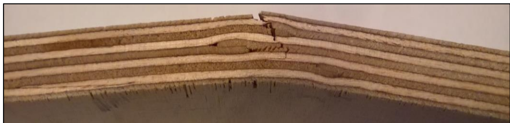
KUVA 33. Viilupintaisen limittymän sisältämän vanerin murtuminen
