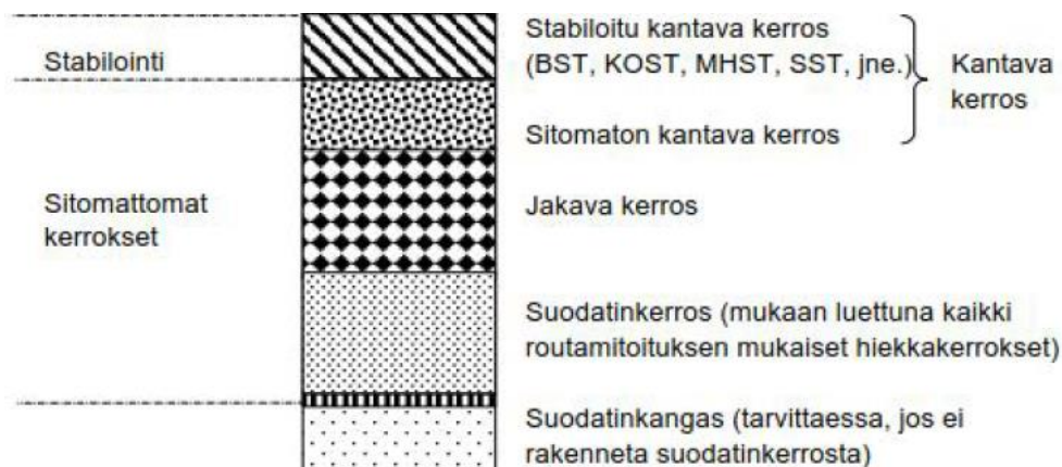
KUVA 9. Päällysrakennekerrosten nimitykset (Tiehallinto 2004).
