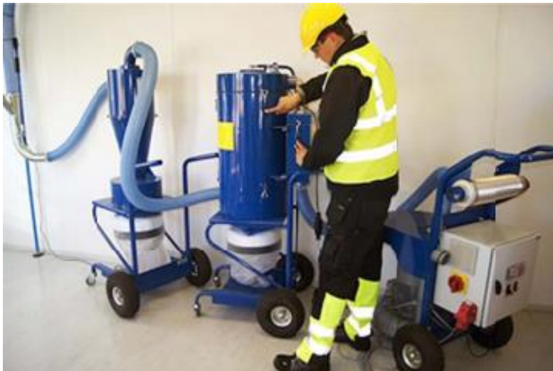
KUVA 4. Keskuspölynimuri, jossa erilliset esisuodatus-, suodatus- ja moottoriyksiköt.
