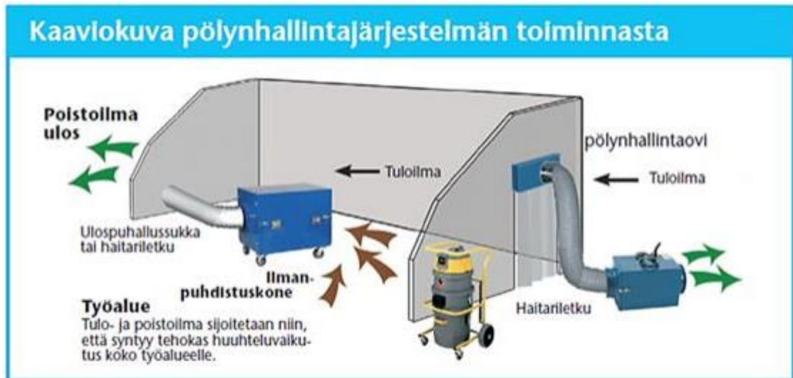
KUVA 2. Osastoinnin alipaineistus. (Tienhaara 2016, 19.)
