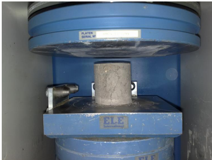
KUVA 1. Betonikoekappale koestuksen jälkeen
