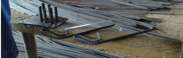
KUVA 5. Tarpeen tullen raudoittaja valmistaa rautasahoja
