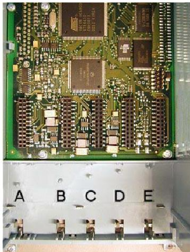
KUVIO 3. Ohjauskortin korttipaikat optiokorteille (Vacon NXS ja Vacon NXP). (Vacon 2007, 4.)
