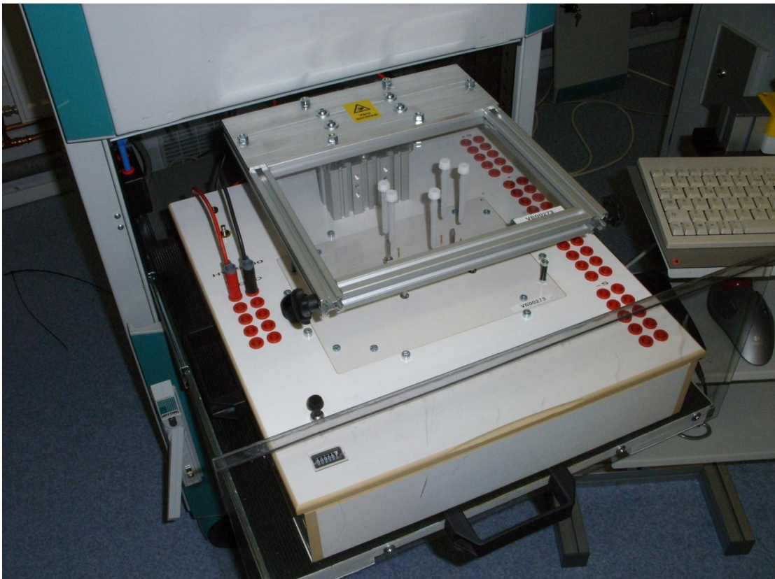
KUVIO 12. Fixtuuri asennettuna testaustorniin ja adapteri OPT-A2 optiokortille.
