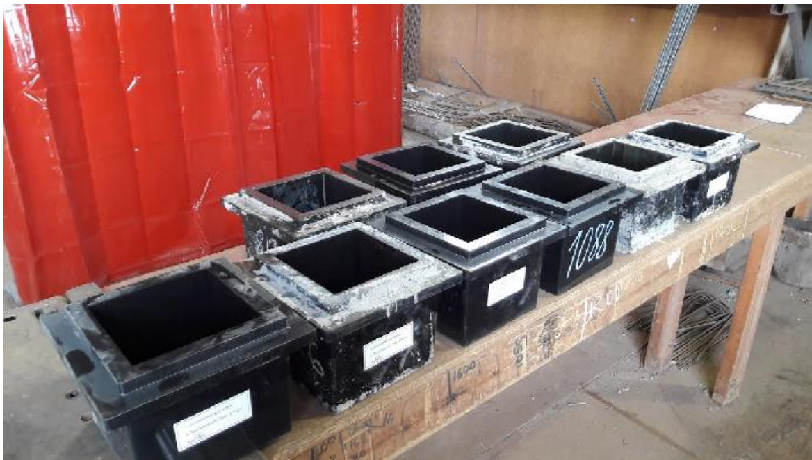
Kuva 8. Koekuutioiden muotit öljytyinä, valmiina valamista varten.
