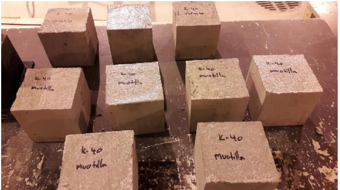
Kuva 10. Koekuutiot muoteista purettuina 16 h kuivumisen jälkeen.
