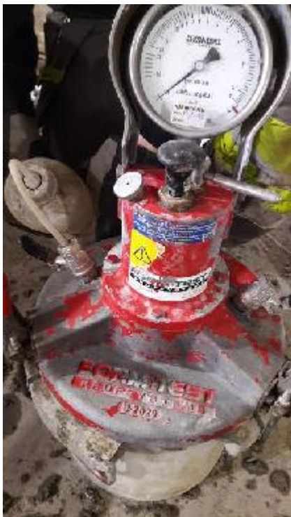
Kuva 2. Veden ruiskuttaminen ilmamäärämittariin, jäljellä olevan ilman poistamiseksi.
