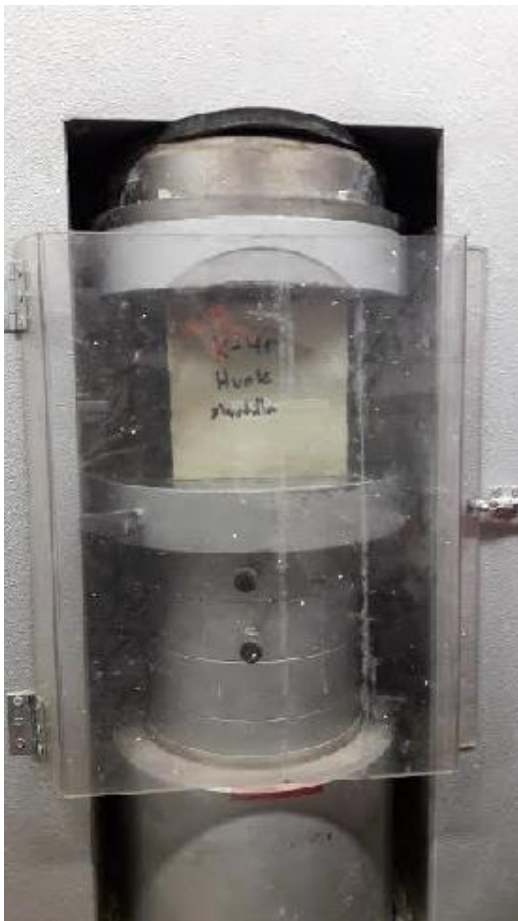
Kuva 11. Huokostetusta betonista valmistetun olosuhdekoekuutien puristuskoelaitteen sisällä.
