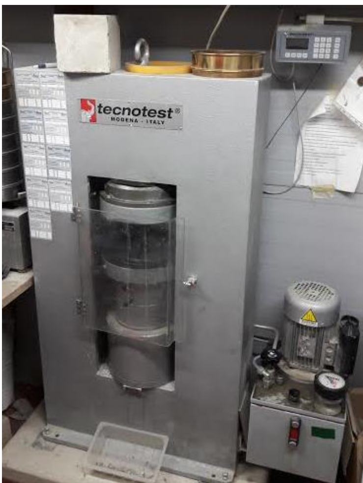
Kuva 7. Betonin puristuslujuuden testauskone.
