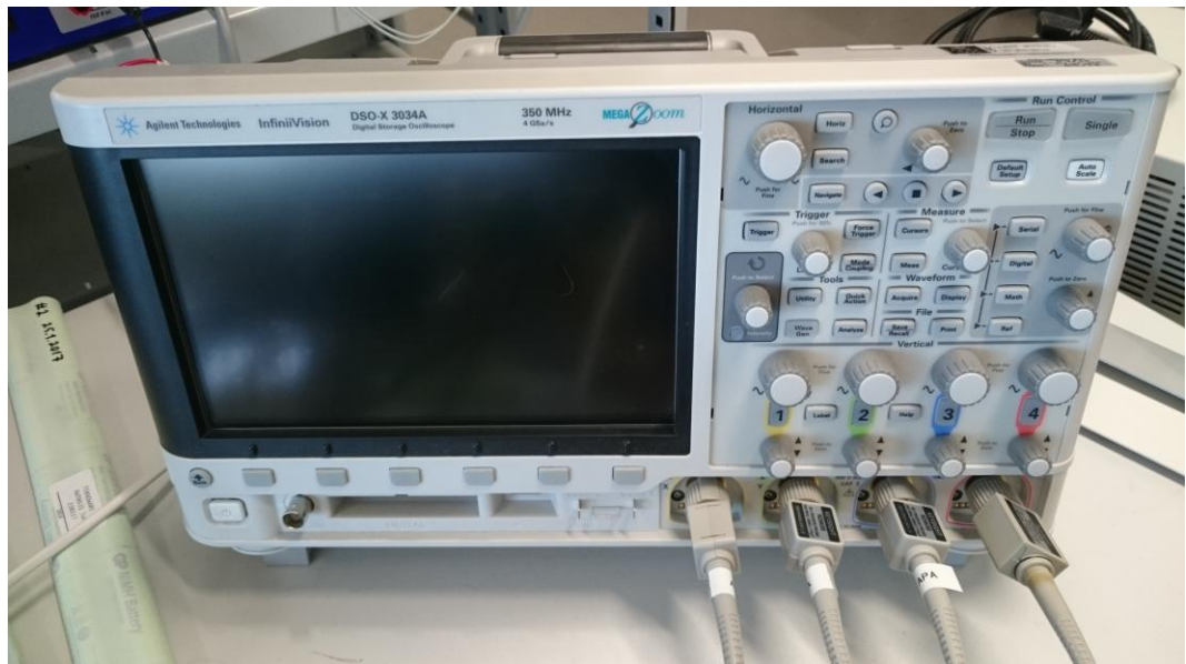
Kuva 3. Agilent InfiniiVision DSO-X 3034A oskilloskooppi
