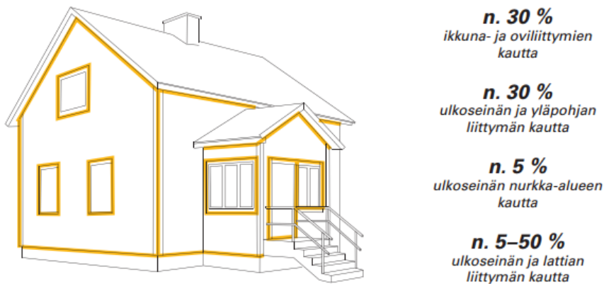
KUVA 9. Tyypilliset vuotokohdat talossa (34, s.1.)
