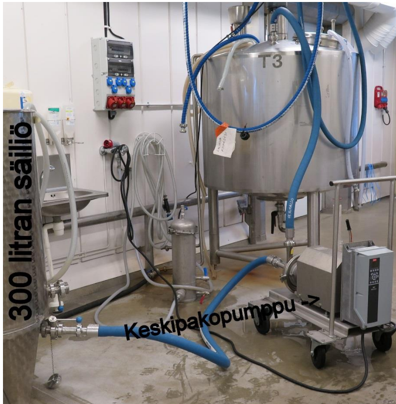
Kuva 8. Keskipakopumppu kiinnitettynä tuotesäiliöön
