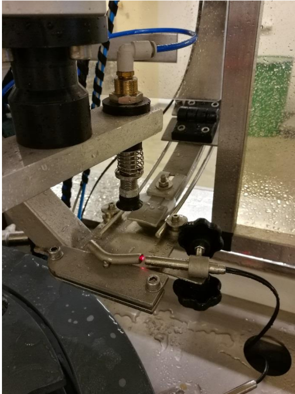
Kuva 26. Korkki jumissa korkinsyöttäjässä (lavastettu tilanne)
