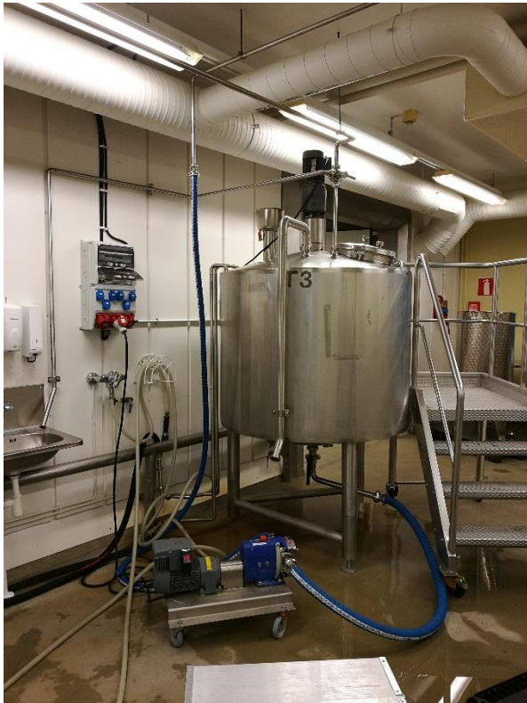
Kuva 6. Mehun pumppaus pastööriin
