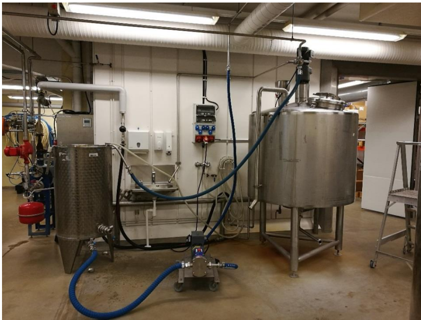
Kuva 23. Pastööri ja tuotesäiliö lopuksi
