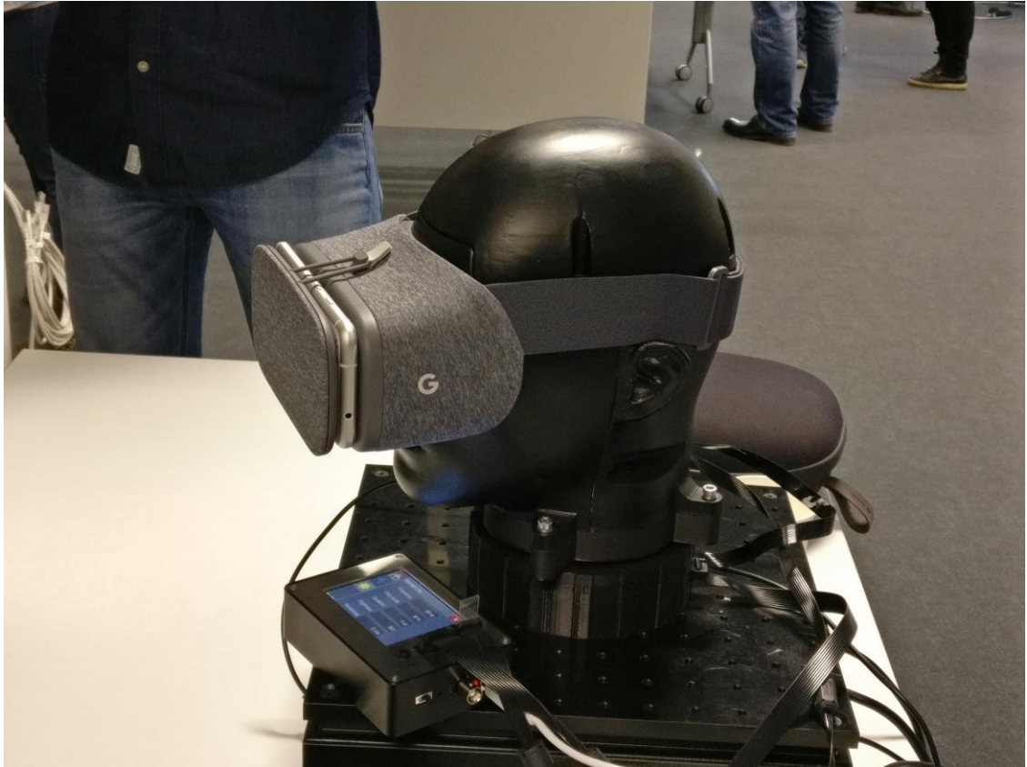
KUVA 13. Google Daydream -virtuaalilasit yhdistettynä Google Pixel -matkapuhelimen kanssa.
