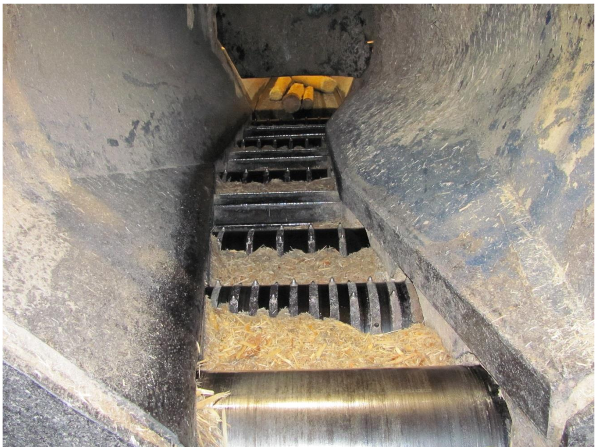
Kuva 15. Kiihdytysrullasto kulmarummulta kuitupuiden tulosuuntaan kohti katsottuna
