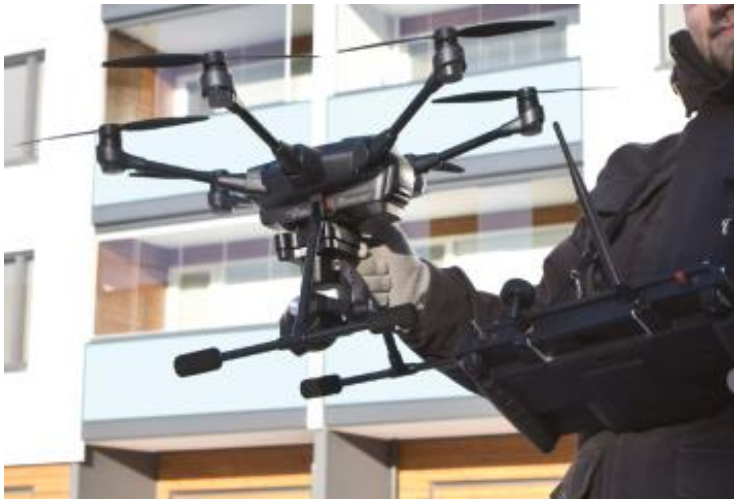
KUVA 1. Kuva kauko-ohjattavasta ilma-aluksesta (heksakopterista) ja sen ohjaimesta.
