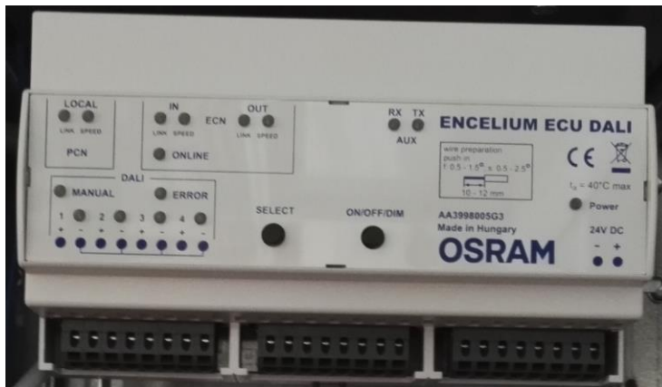
KUVA 5. Encelium-järjestelmän ohjausyksikkö eli ECU (H. Kuusinen, 2017)
