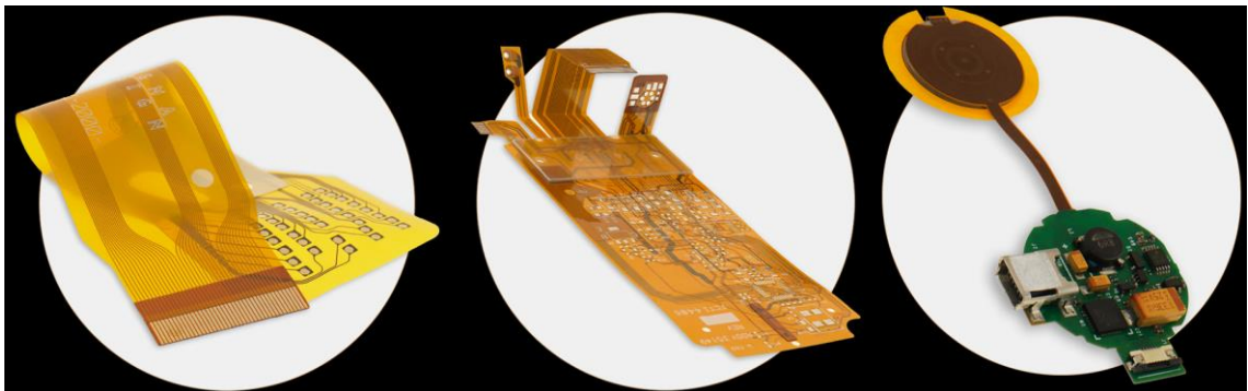
Kuva 6 Kaksoisyhteyksellinen, kaksikerroksinen ja puolijoustava piirilevy [muokattu lähteestä 10.]
