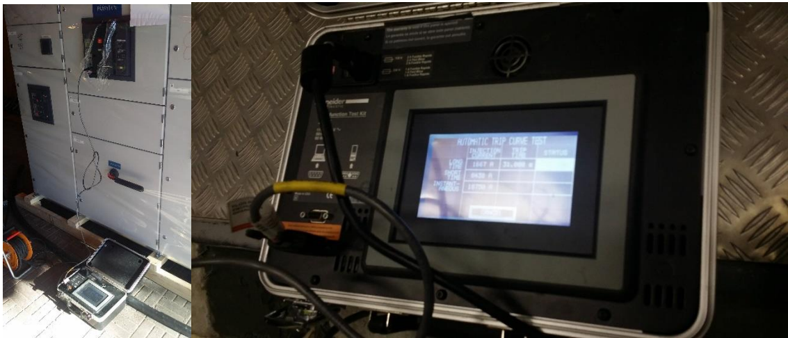
KUVA 9. Kuvasarja pienjännitekatkaisijan koestuksesta Merlin Gerin -koestuslaitteella.
