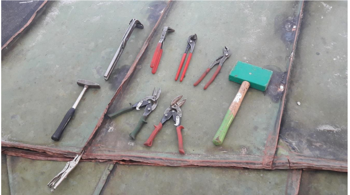
Kuva 21. Kuparikatteen työstämiseen soveltuvia työkaluja.
