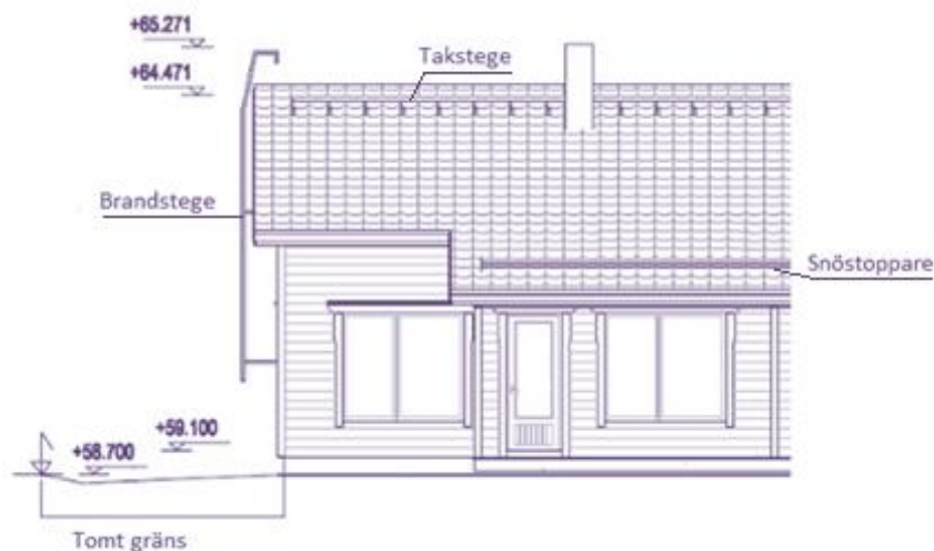
Figur 11. Höjder utmärkt på olika delar av byggnaden samt utrustning på taket.
