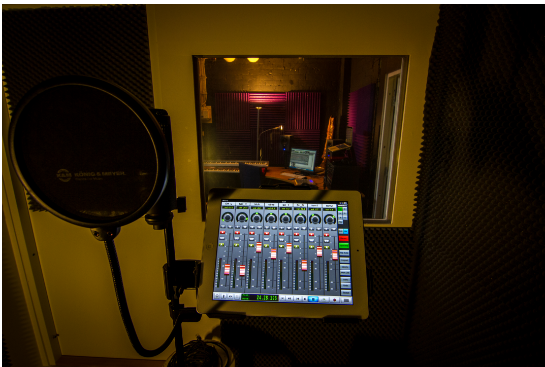
Kuva 28. Pro Toolsin langaton ohjaus toteutettu iPadilla ja V-Control Pro -ohjelmalla.
