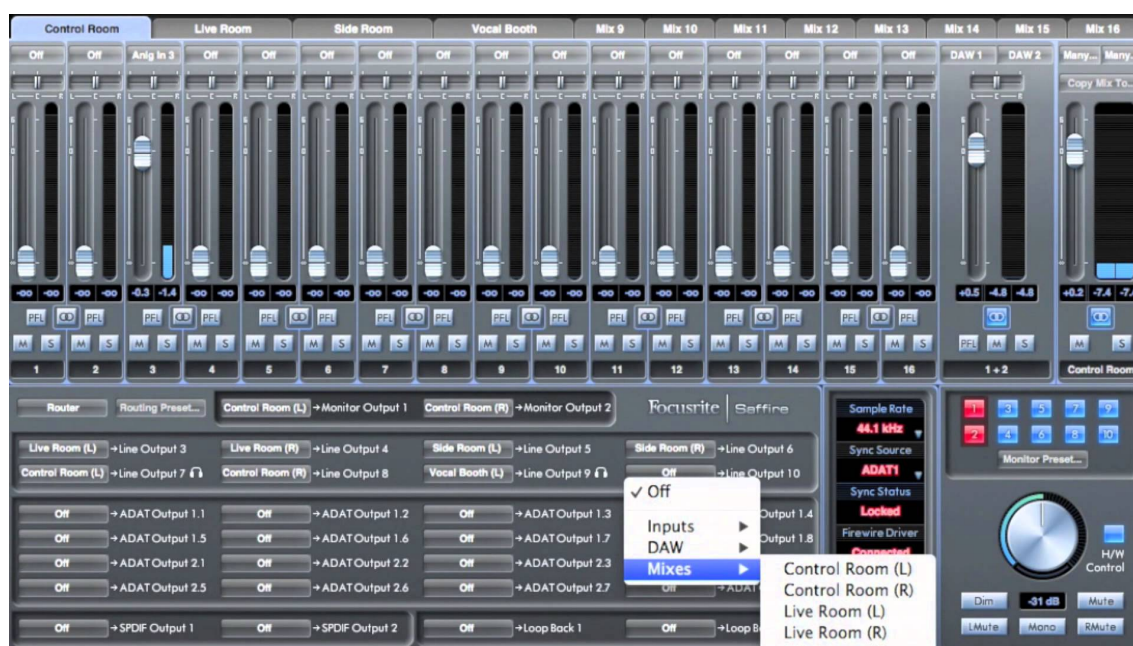
Kuva 24. Focusrite MixControl -ohjelman käyttöliittymä äänenreittitys mahdollisuuksineen.
