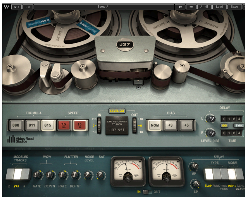
Kuva 29. Waves Audio- yhtiön J37-Tape pluginilla saadaan jäljitettyä analogisen kelanauhurin soundia digitaaliseen äänitteeseen.
