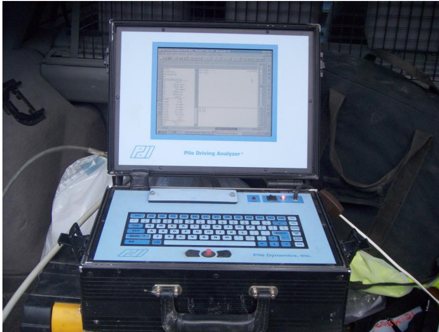
Kuva 12: PDA- mittauksessa käytettävä tietokone.
