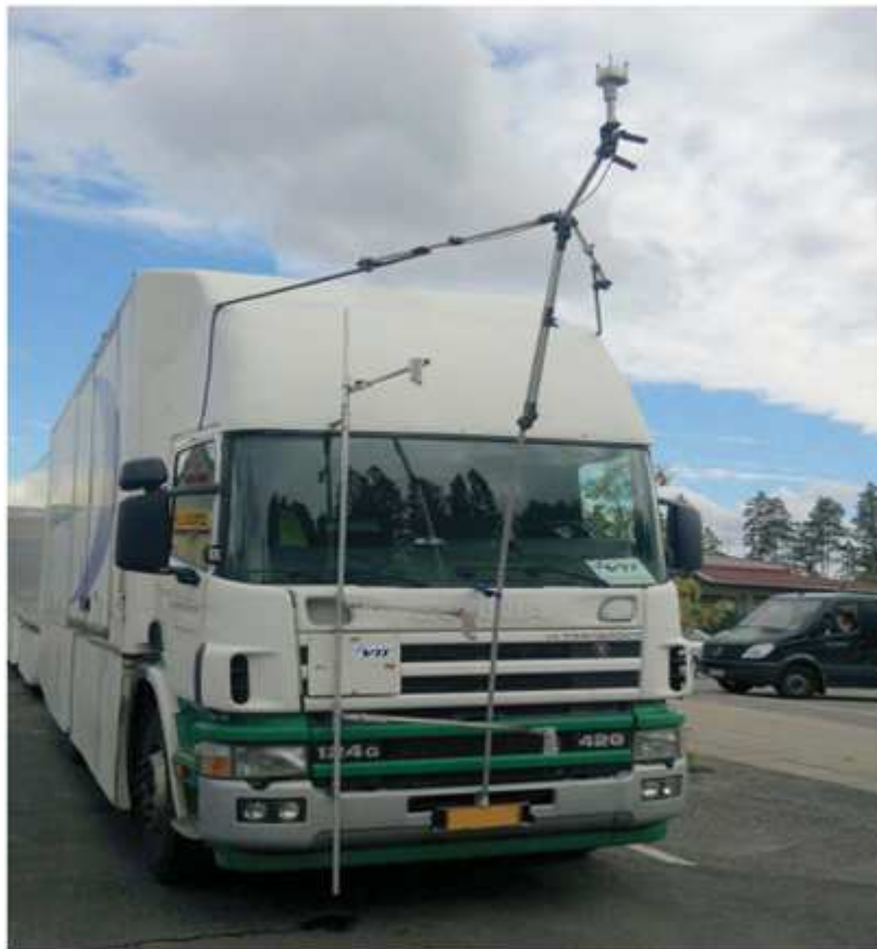
KUVA 54. Tuulianturin sijoitus optimaaliseen kohtaan ajoneuvon eteen (17, s. 73)
