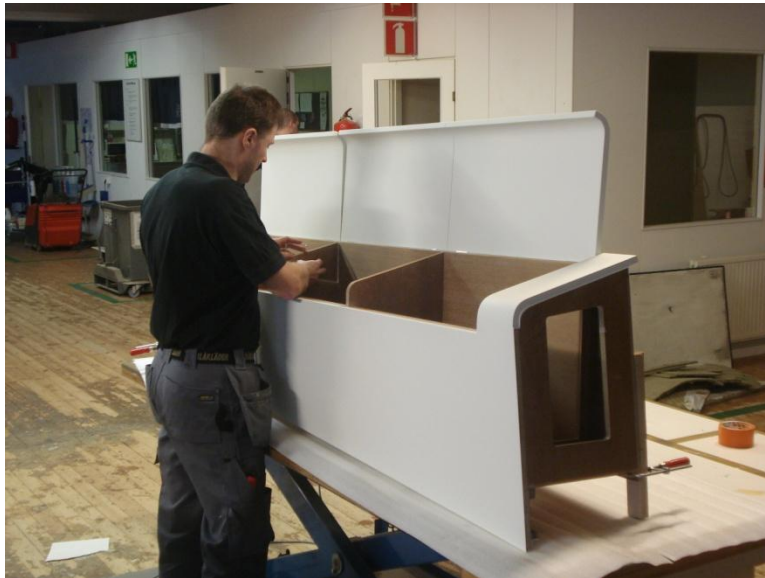
KUVA7. Yläkaapin ovien hienosäätöä S60
