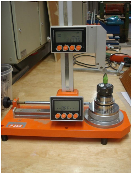
KUVA 16. Työkalun mittaaminen Preset 368 -mittalaitteessa.
