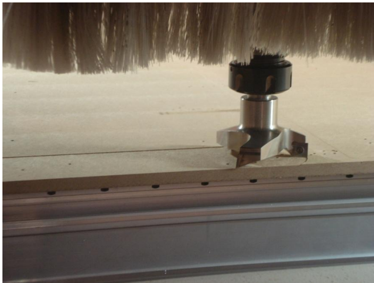
KUVA 20. 70 mm plaanausterä poistaa millimetrin uhrilevyn pinnasta
