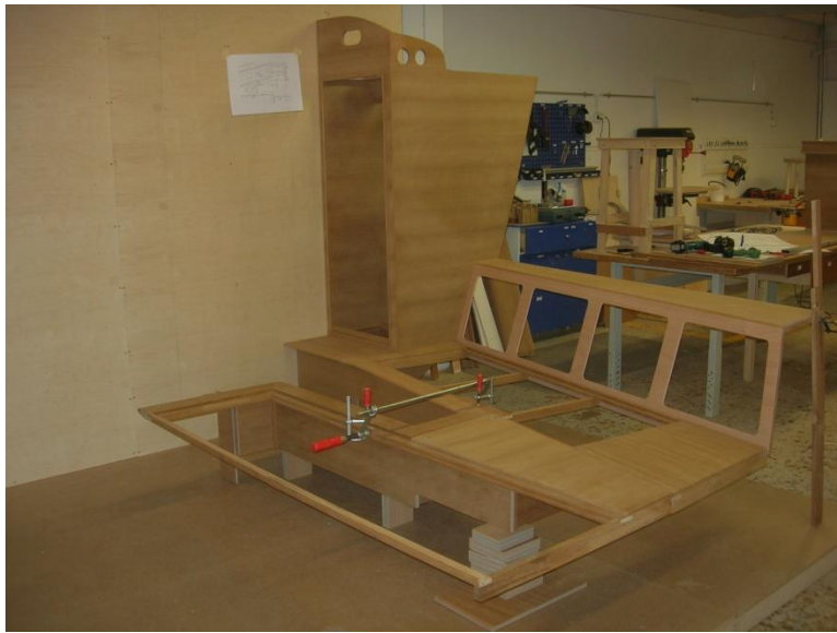
KUVA 6. Kalusteet esiasennettuna S60-perähyttiin
