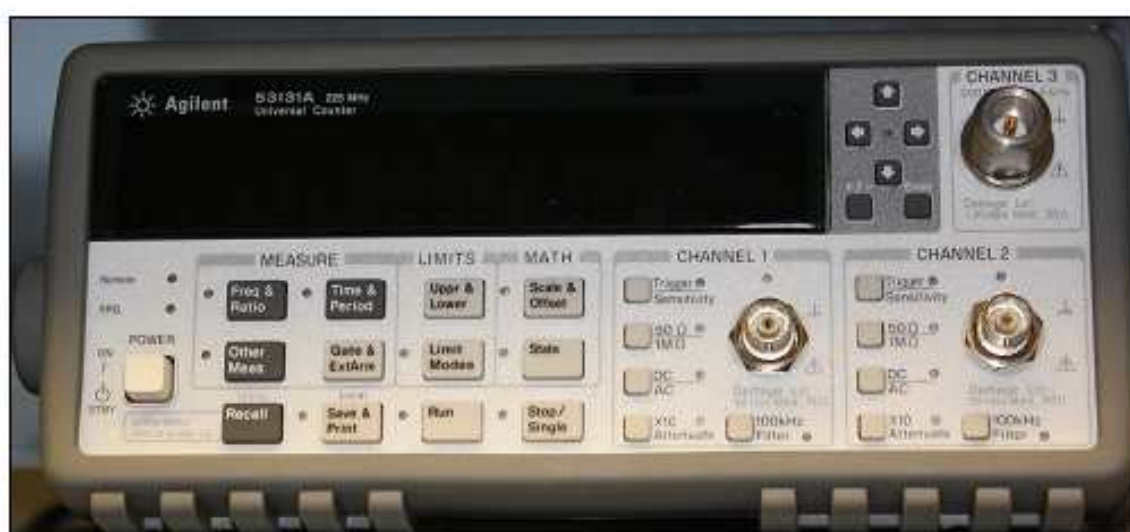
Kuva 17. Agilentin taajuuslaskuri 53131A.
