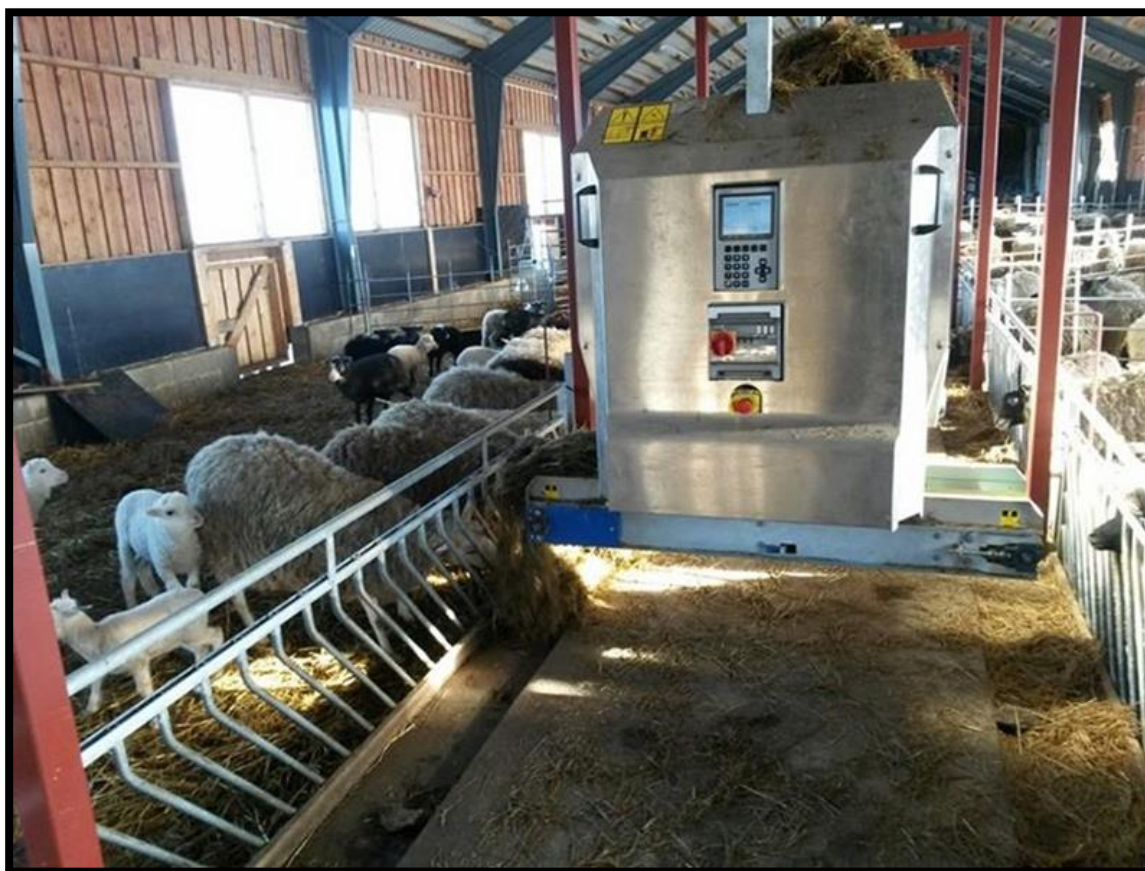
KUVA 37. Karkearehunjakovaunu OTS1600 jakaa lampailla rehua 20 kertaa vuorokaudessa (Herrakunnan Lammaset Oy s. a.)
