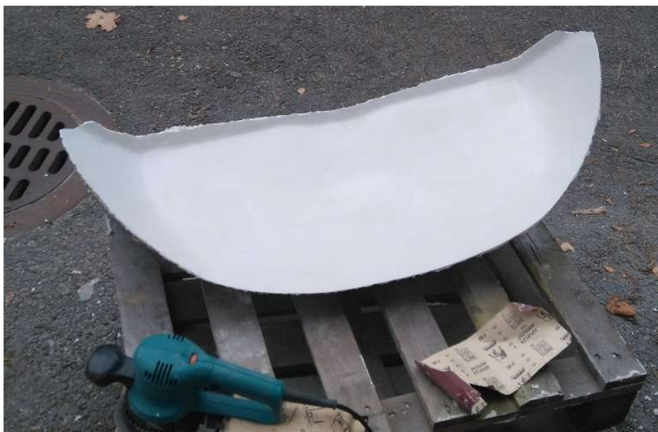
KUVA 50. Kitattu ja hiottu uretaanimuotti.
