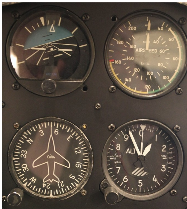
KUVA 14. Yllä keinohorisontti ja ilmanopeusmittari sekä alla kompassi ja korkeusmittari
