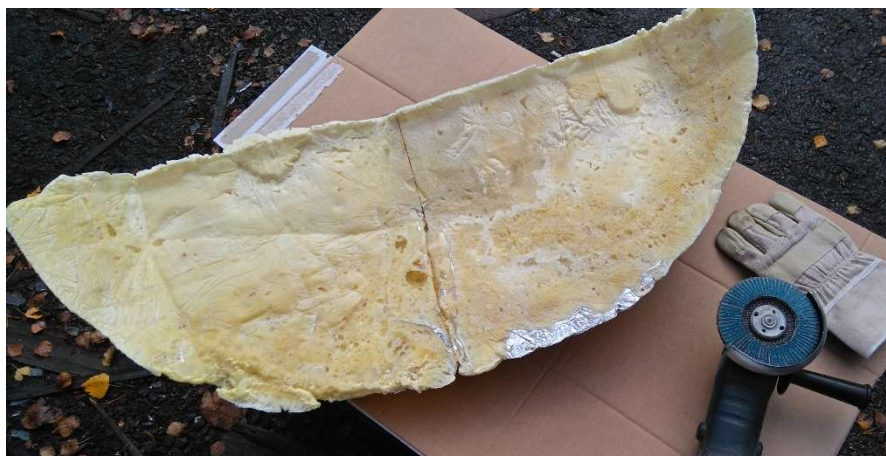
KUVA 49. Uretaanimuotin tasoitus ja pinnan muokkaus.
