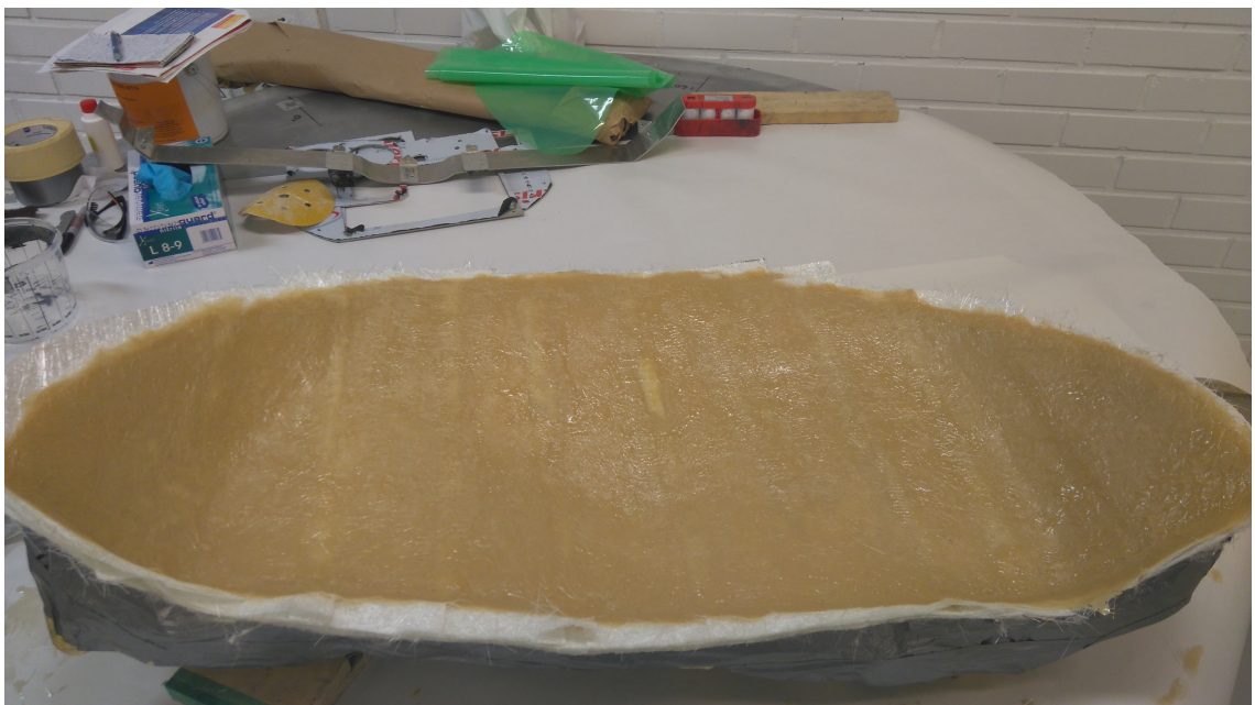
KUVA 61. Lasikuitumuotti laminoitu ja kuivumassa.
