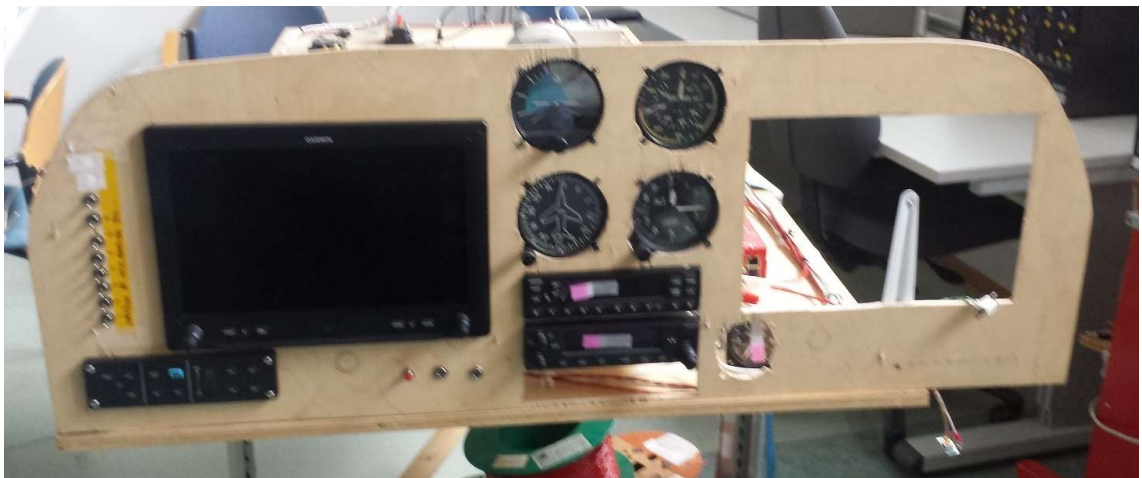
KUVA 5. Osa halutusta avioniikasta hahmotelmapaneelissa.
