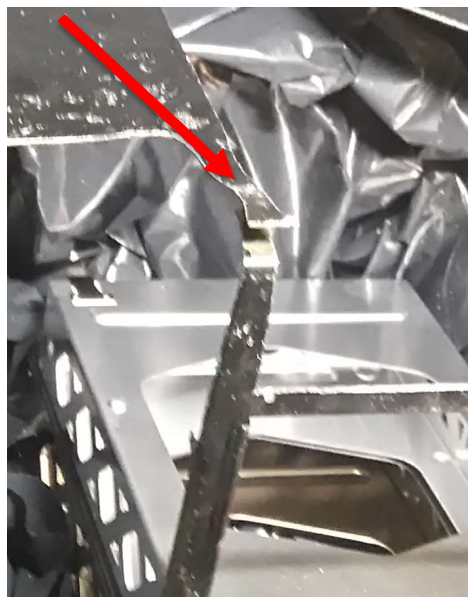
KUVA 23. Havaittu erkaantunut yhtymävyöhyke.
