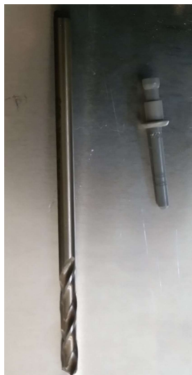
KUVA 25. Valittu työniitti ja asennusporanterä
