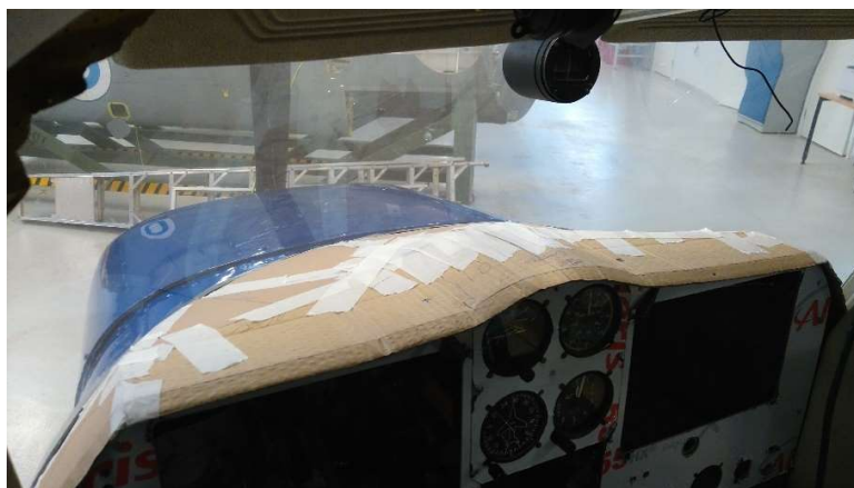
KUVA 44. Pahvihahmotelma muotosuojaa varten.
