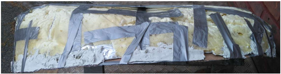
KUVA 93. Muotin epäkohtien kittaamista.
