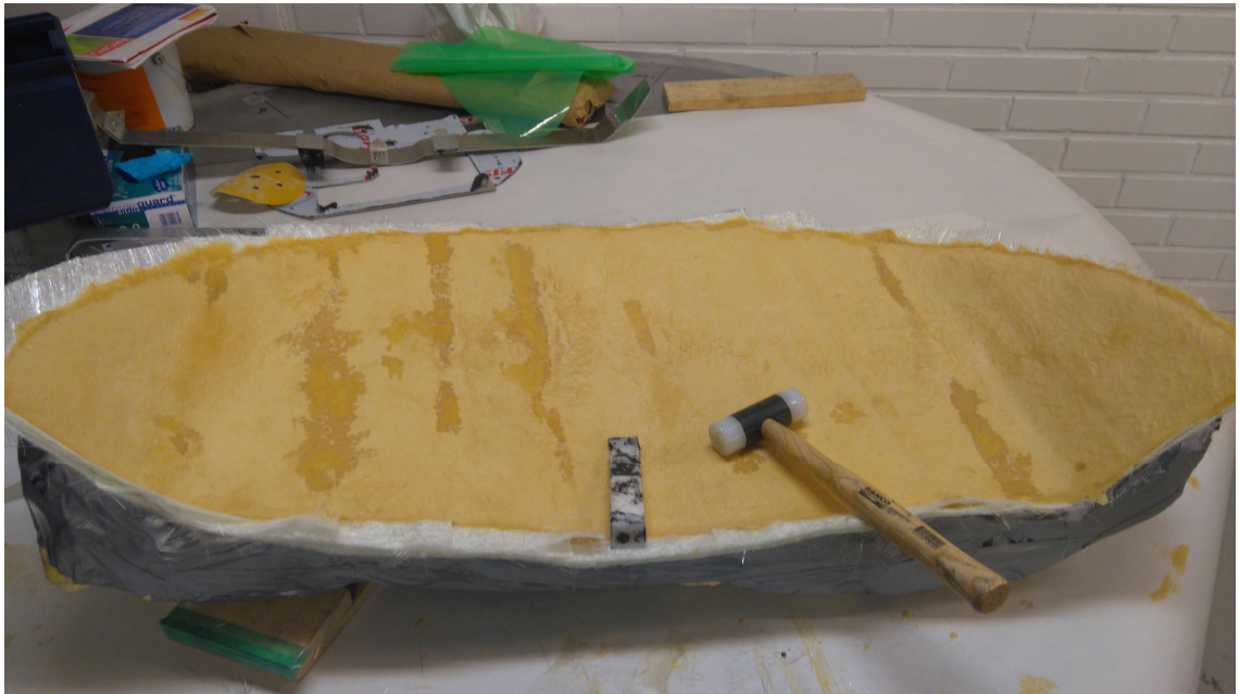
KUVA 62. Kuivunut lasikuitumuoto irrotus valmis.
