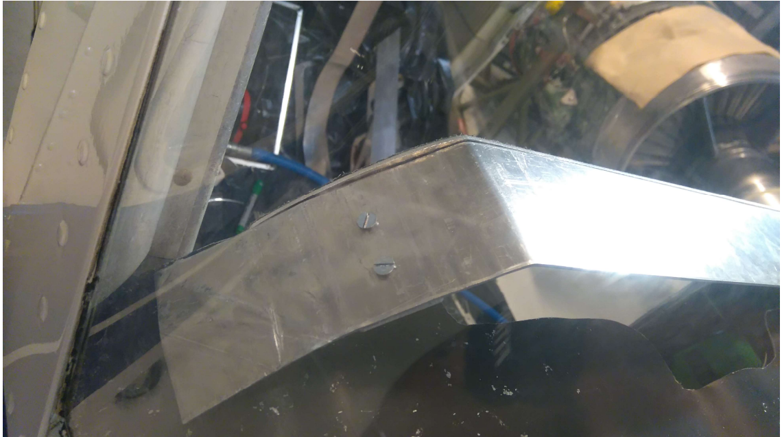
KUVA 37. Kiinnityskorvakkeen asennus apupilotin istuimen puolelta.
