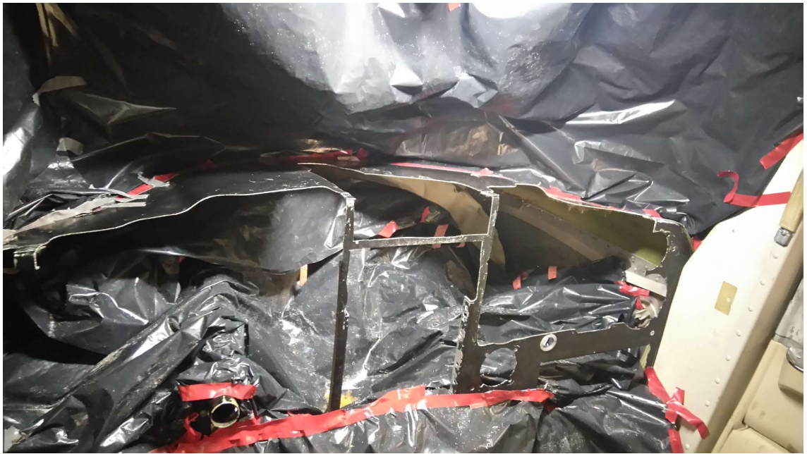
KUVA 26. Ohjaamon muokkaus valmis koeasennukseen.
