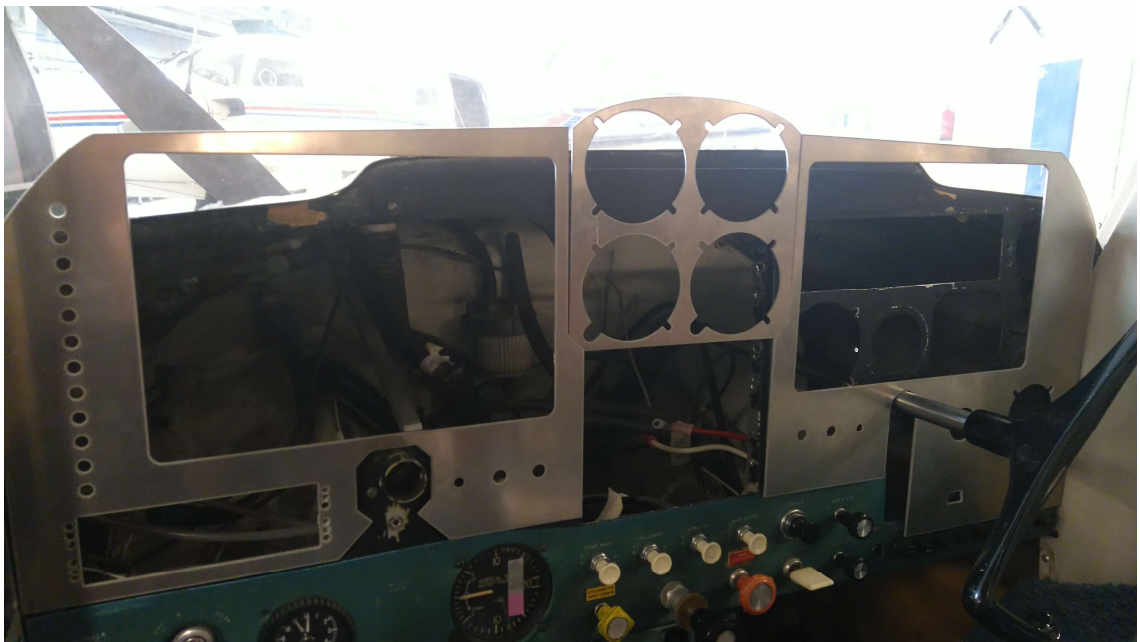
KUVA 17. Ohjaamon rajoitukset ala-, sivu- ja yläsuunnassa.
