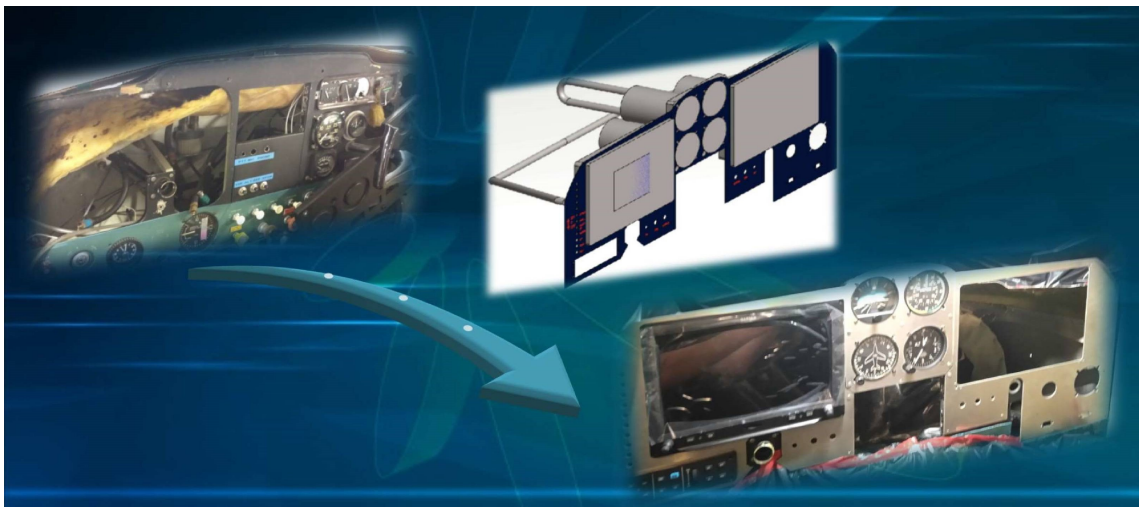
KUVA 4. Ohjaamon alkutilanne, prototyypimallinnos ja valmis prototyypipaneelisto.
