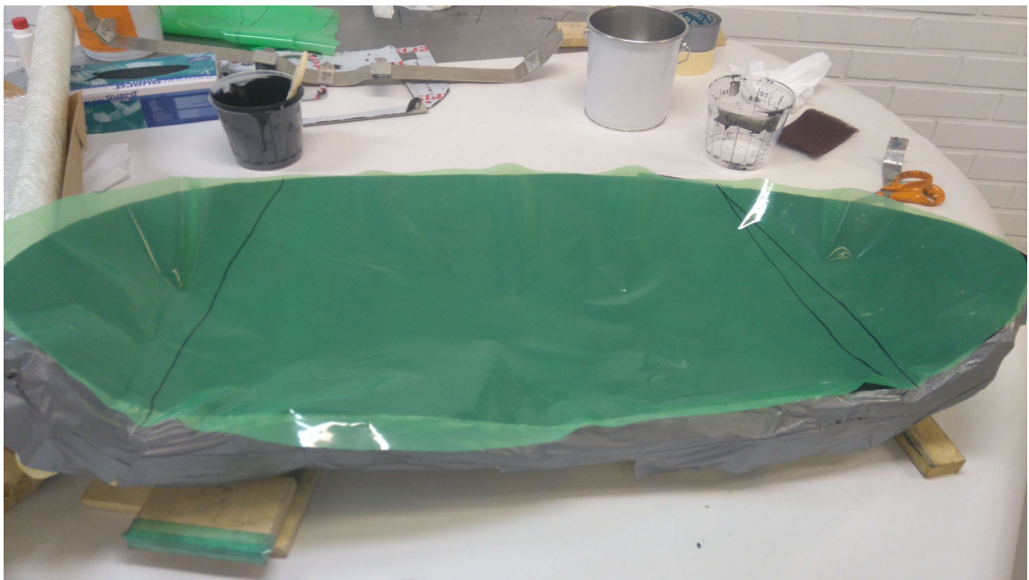
KUVA 54. Muotin suojaaminen teippaamalla reunoista ja kuidunleikkausmalli.
