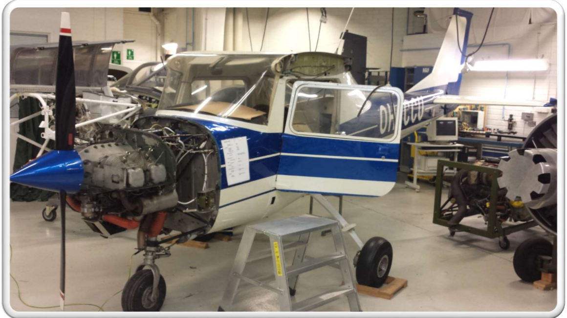
KUVA 1. Cessna 150/152 ilman siipiä ja moottorinsuojusta.
