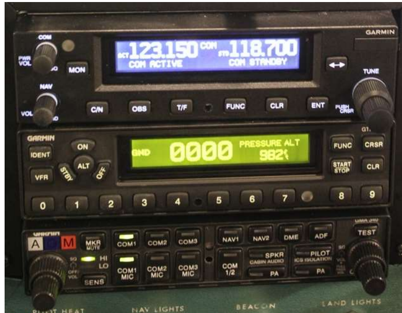
KUVA 13. Ylimpänä radio, Keskellä Tutkavastaaaja ja alhaalla signaalinhallintayksikkö
