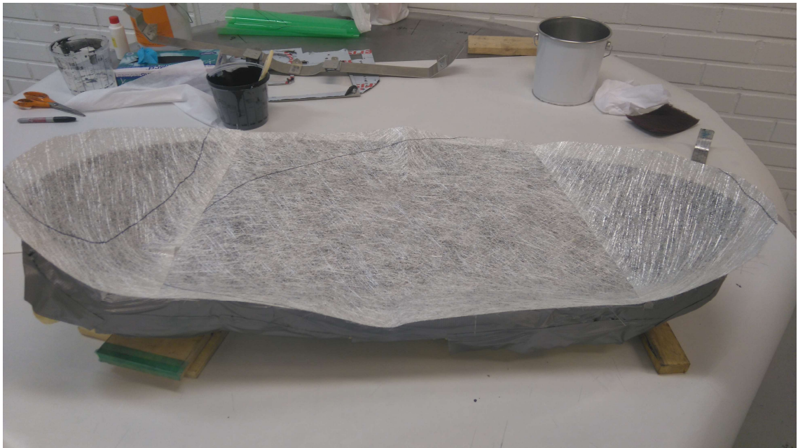
KUVA 57. Ensimmäinen lasikuitumattokerros paikalleen aseteltuna.
