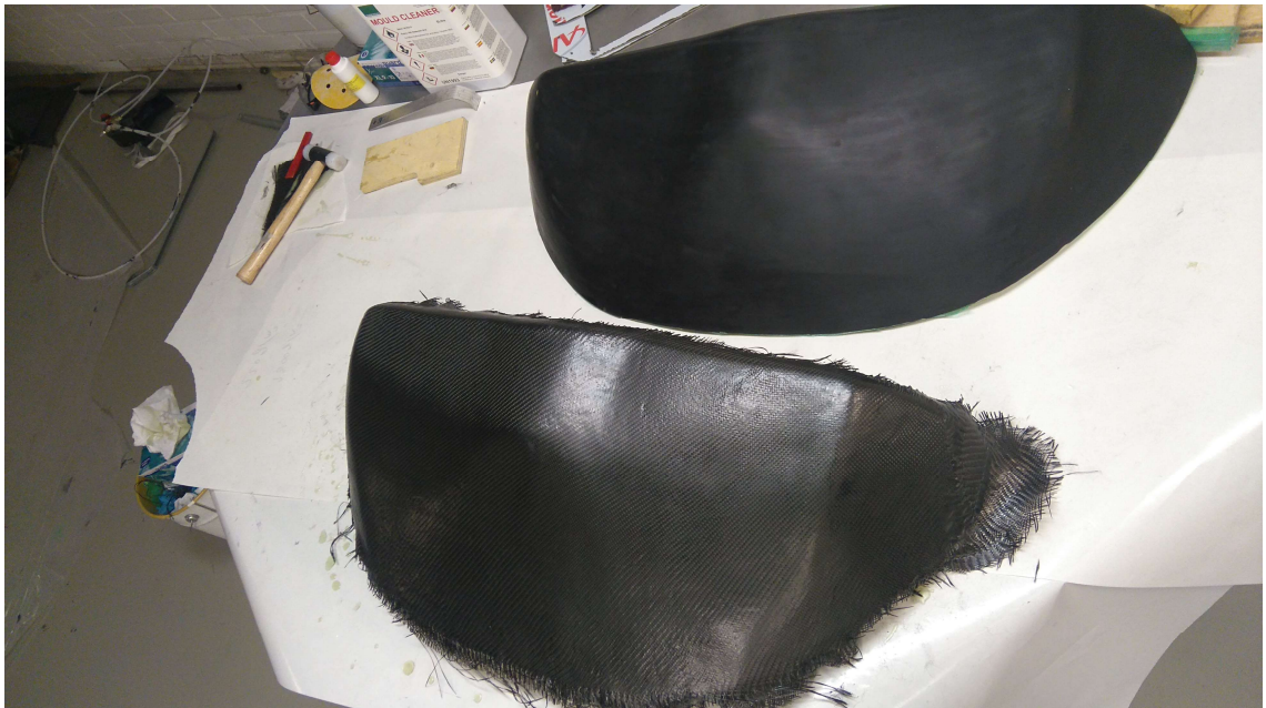
KUVA 68. Irrotettu hiilikuitumuoto ja vahingoittumaton muotti
