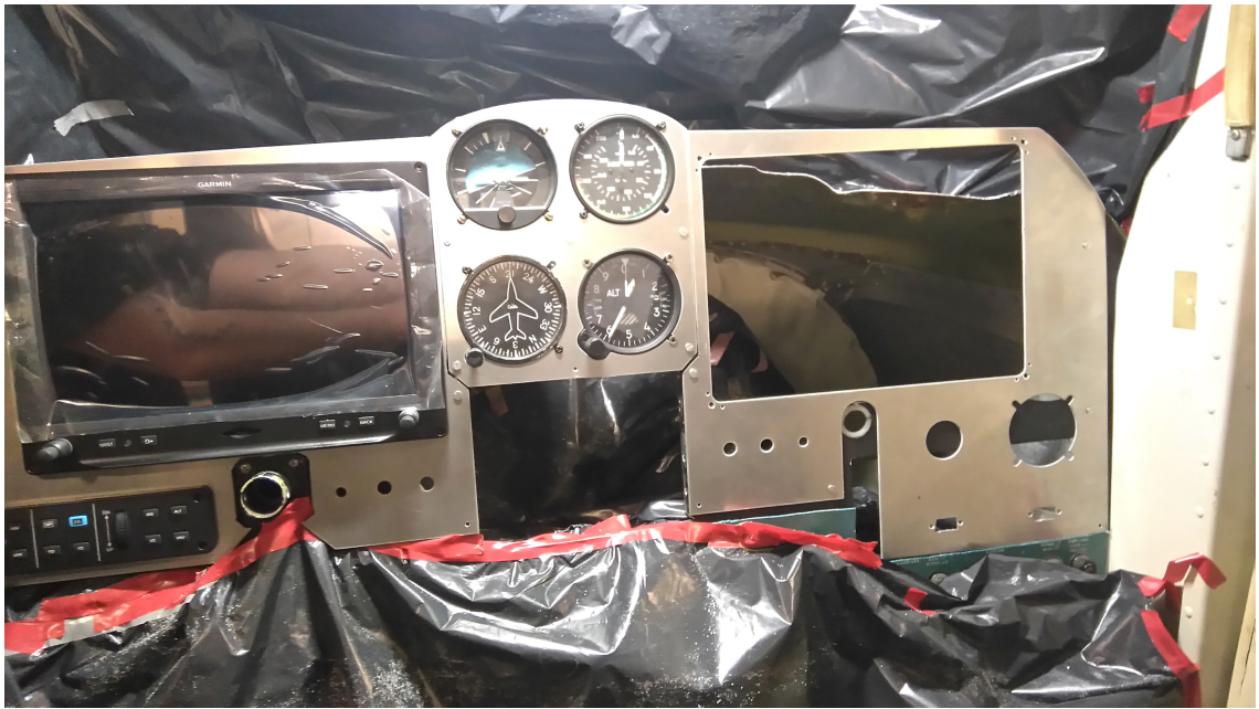
KUVA 28. Koeasennus asennusreikien poraamisen jälkeen.
