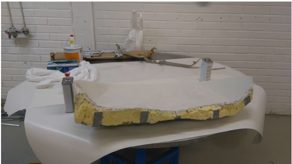
KUVA 53. Muotin irrotusainekäsittely lasikuituvedoksen valmistusvaiheen alussa.
