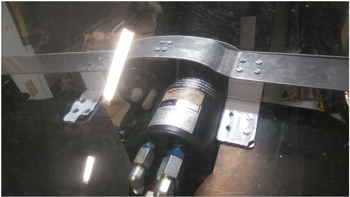
KUVA 39. Korvakkeiden asennus keskelle.
