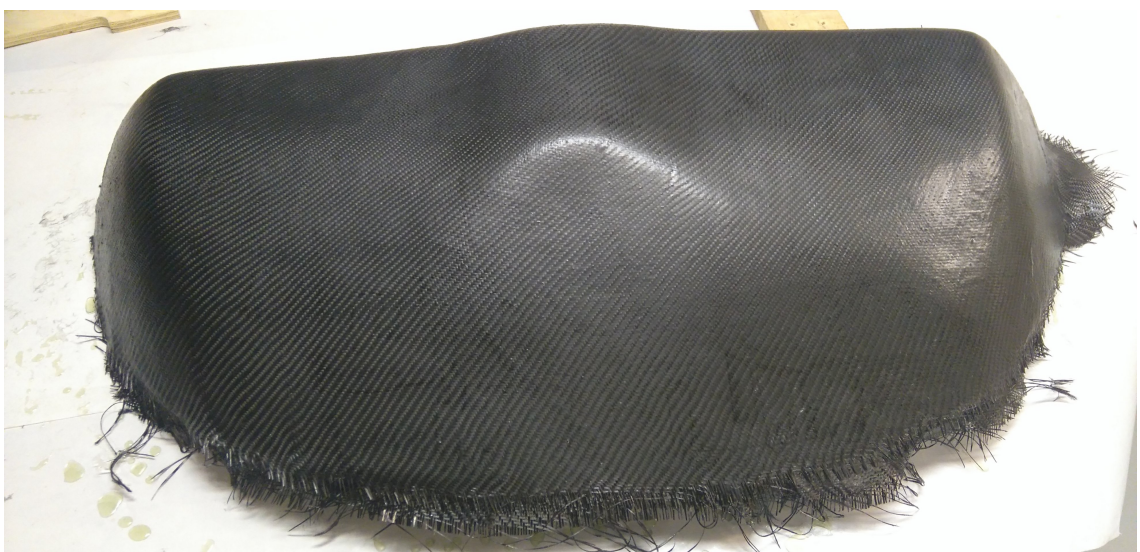
KUVA 67. Kuivunut hiilikuitumuoto, ensimmäinen laminointikerta.
